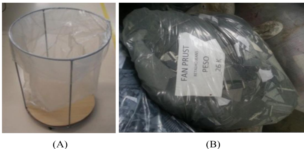
FIGURA 41 – Suporte para colocação de saco transparente para recolha de resíduos têxteis do setor de corte
