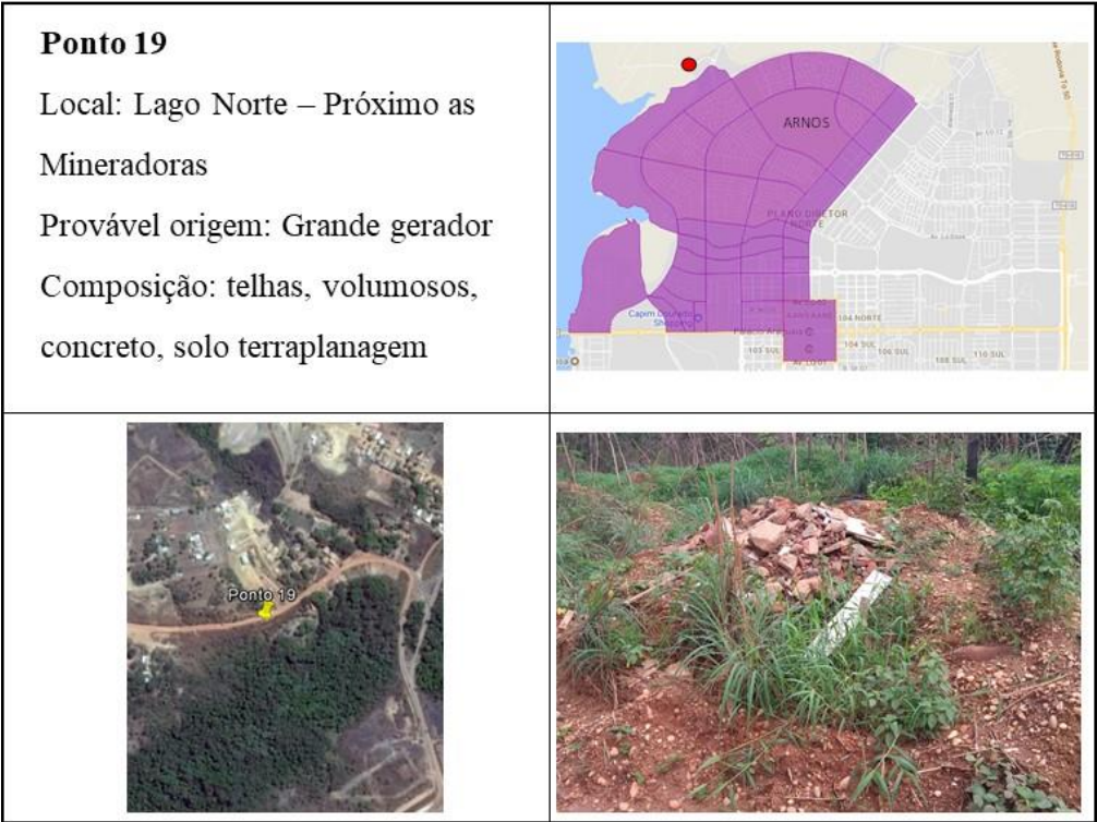
Figura 59: Ponto 19 de lançamento clandestino de RCC na região norte.
