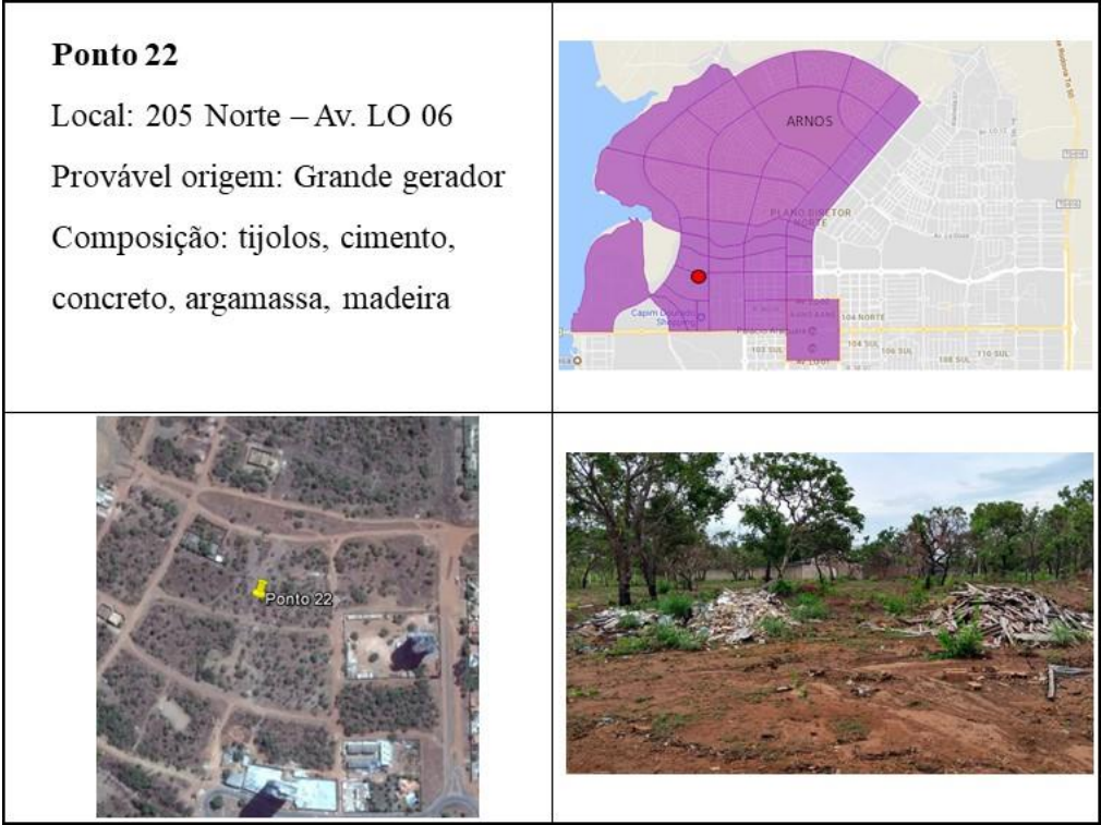
Figura 62: Ponto 22 de lançamento clandestino de RCC na região norte.
