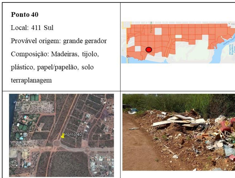
Figura 80: Ponto 40 de lançamento clandestino de RCC na região sul.
