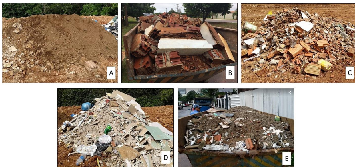
Figura 8: RCC de diferentes origens que foram caracterizados na pesquisa: (A) Terraplanagem; (B) Demolição; (C) Reforma; (D) Construção nova térrea; (E) Construção nova vertical)
