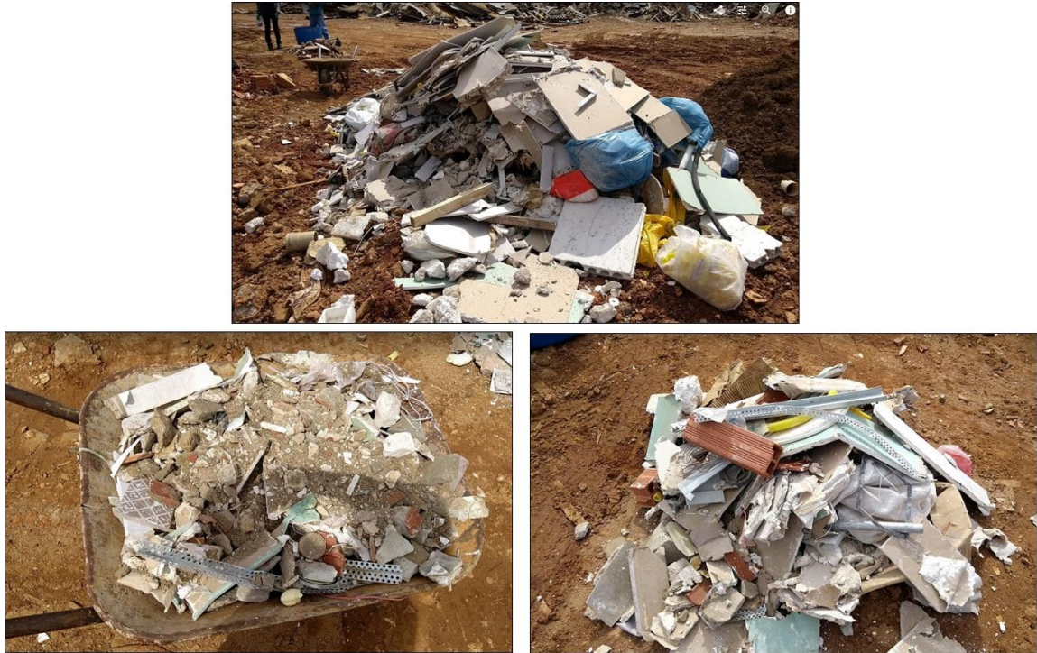
Figura 9: Coleta da amostra composta para caracterização dos resíduos. Na parte superior, a pilha inteira do contêiner. Na parte inferior esquerda, coleta de uma amostra de 25 L, e do lado direito a amostra composta de 150 L
