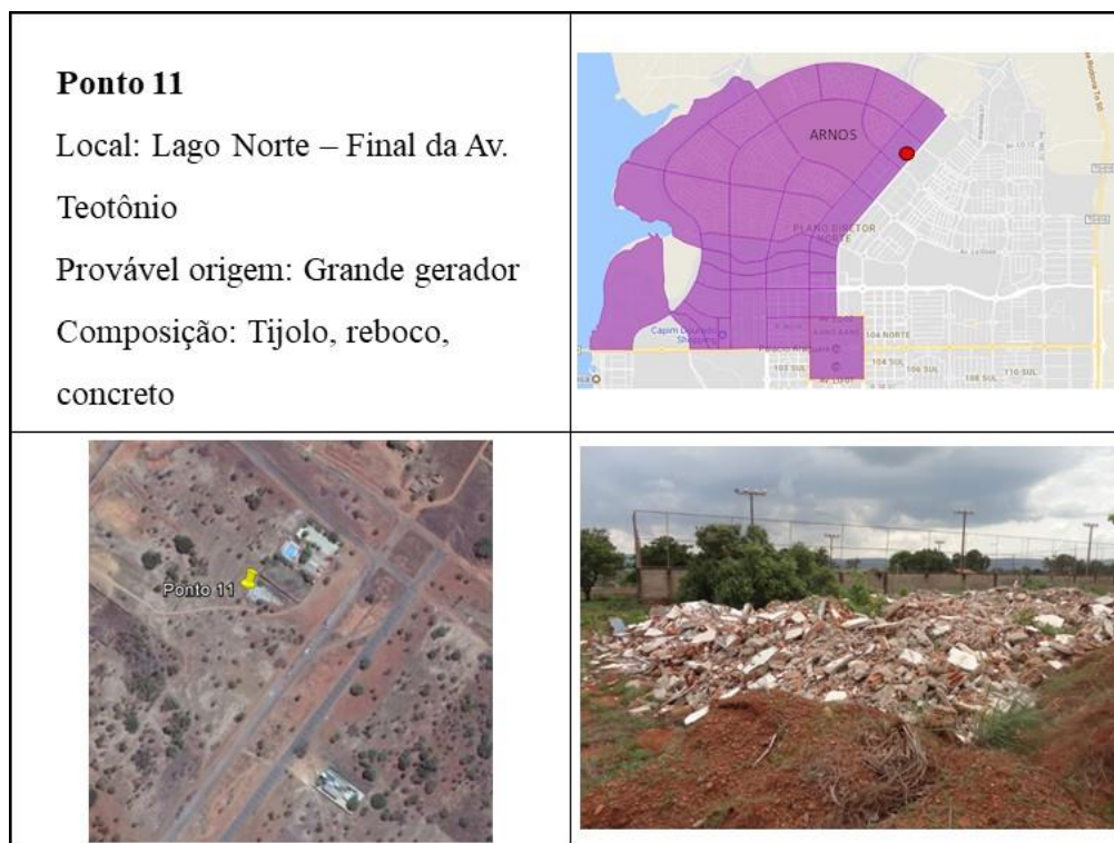
Figura 51: Ponto 11 de lançamento clandestino de RCC na região norte.
