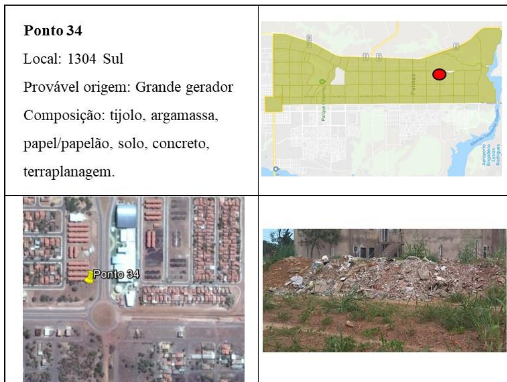
Figura 74: Ponto 34 de lançamento clandestino de RCC na região sul.
