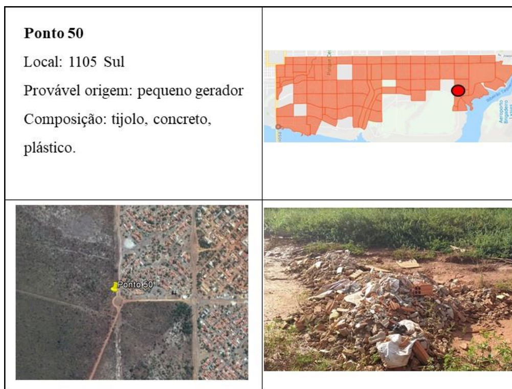
Figura 90: Ponto 50 de lançamento clandestino de RCC na região sul.
