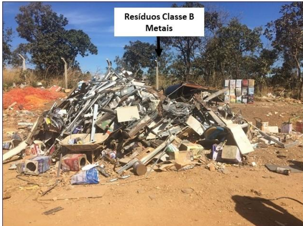
Figura 22: Material separado (metais) na usina de reciclagem de RCC.
