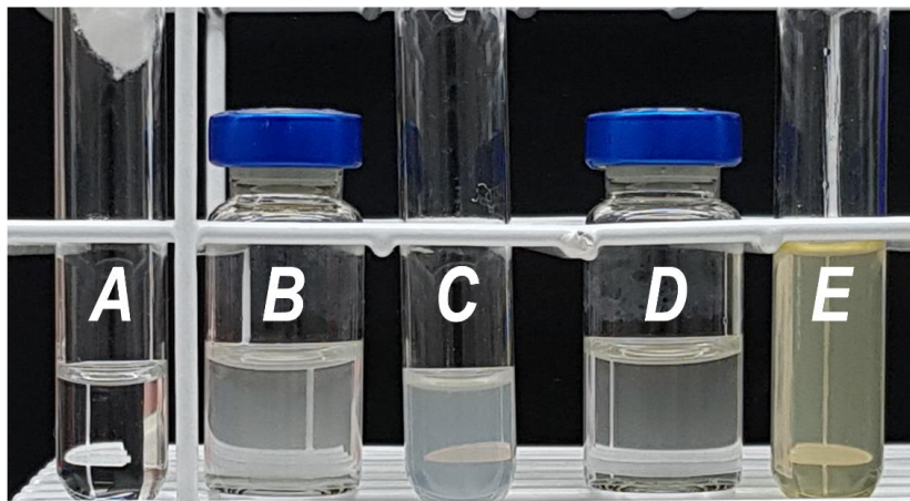
Figura 7 - Obtenção da escala 1 de MacFarland, utilizando do BHI. A – PBS esterilizado sem inóculo; B – Tubo padrão referente à escala 2 de MacFarland; C – Tubo contendo PBS com inóculo, turvado em escala 2 de MacFarland; D – Tubo padrão referente à escala 1 de MacFarland; E – Tubo contendo inóculo final equivalente à escala 1 de MacFarland, formado por igual volume de BHI e inóculo preparado no tubo C.
