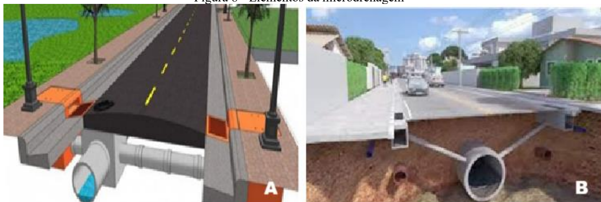
Figura 8 - Elementos da microdrenagem
