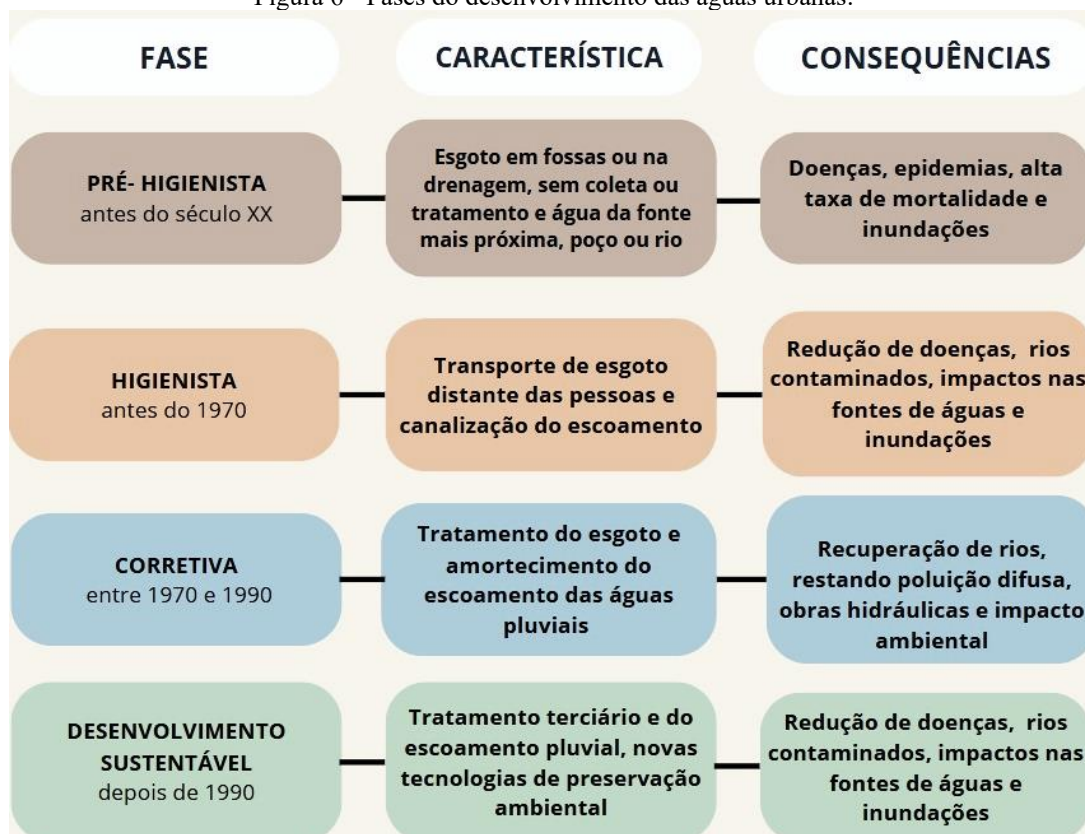
Figura 6 - Fases do desenvolvimento das águas urbanas.
