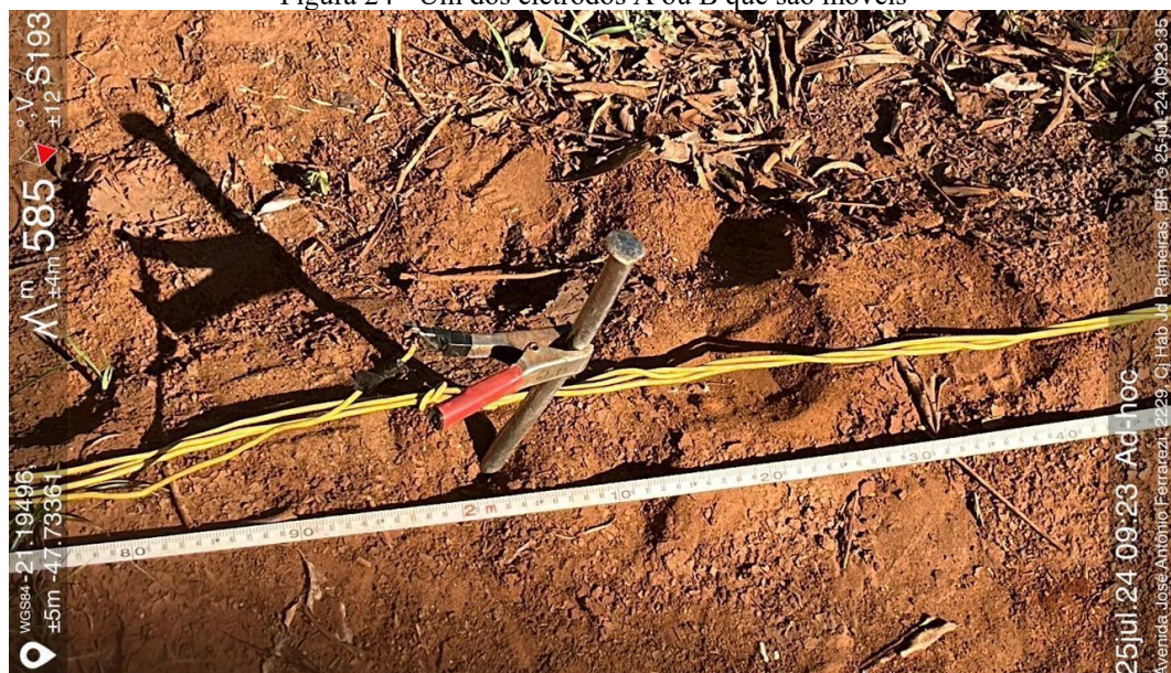
Figura 24 - Um dos eletrodos A ou B que são móveis
