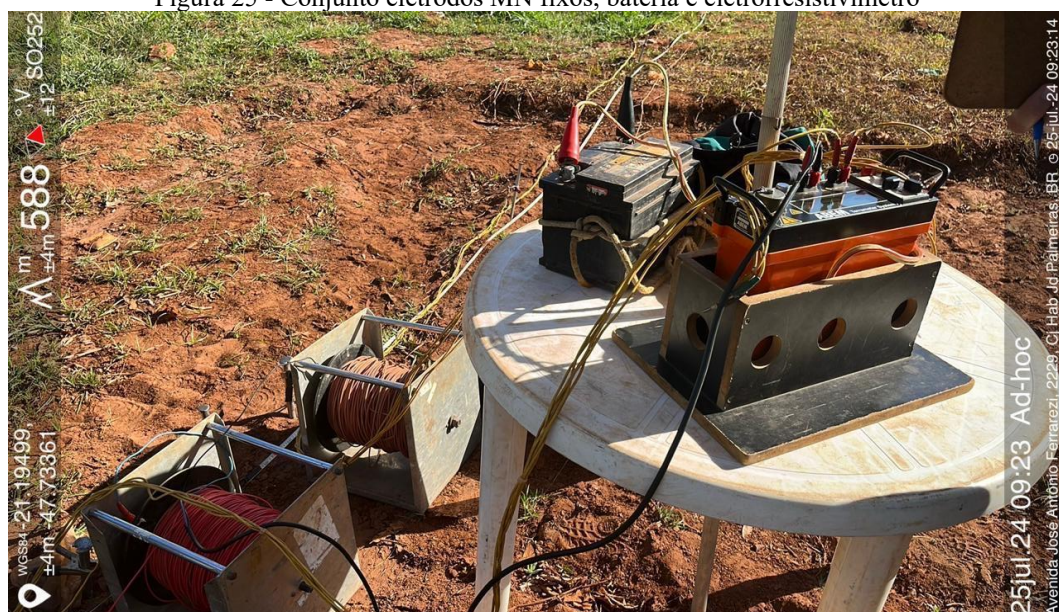
Figura 25 - Conjunto eletrodos MN fixos, bateria e eletrorresistivímetro
