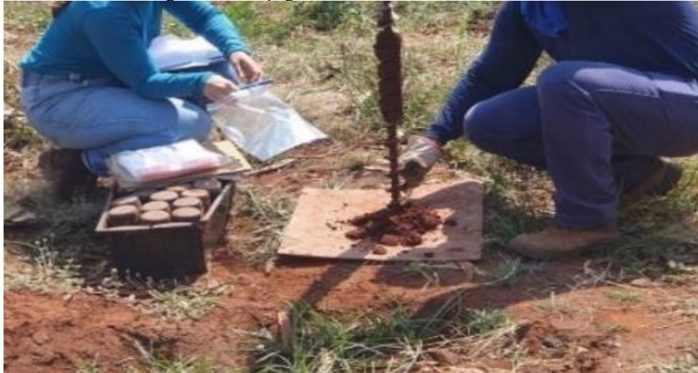
Figura 37 - Raspagem da hélice e coleta das amostras
