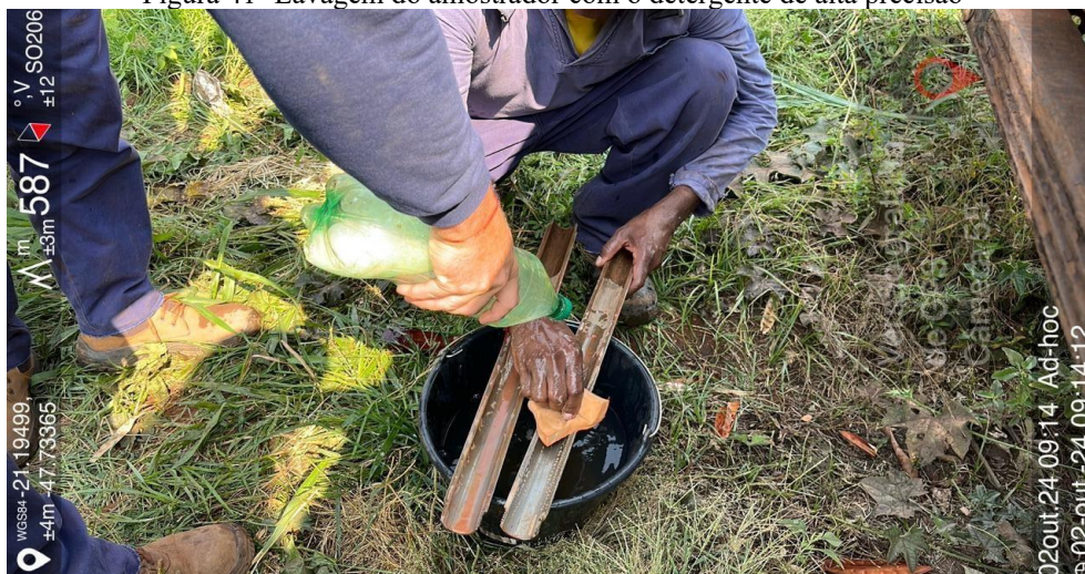
Figura 41- Lavagem do amostrador com o detergente de alta precisão
