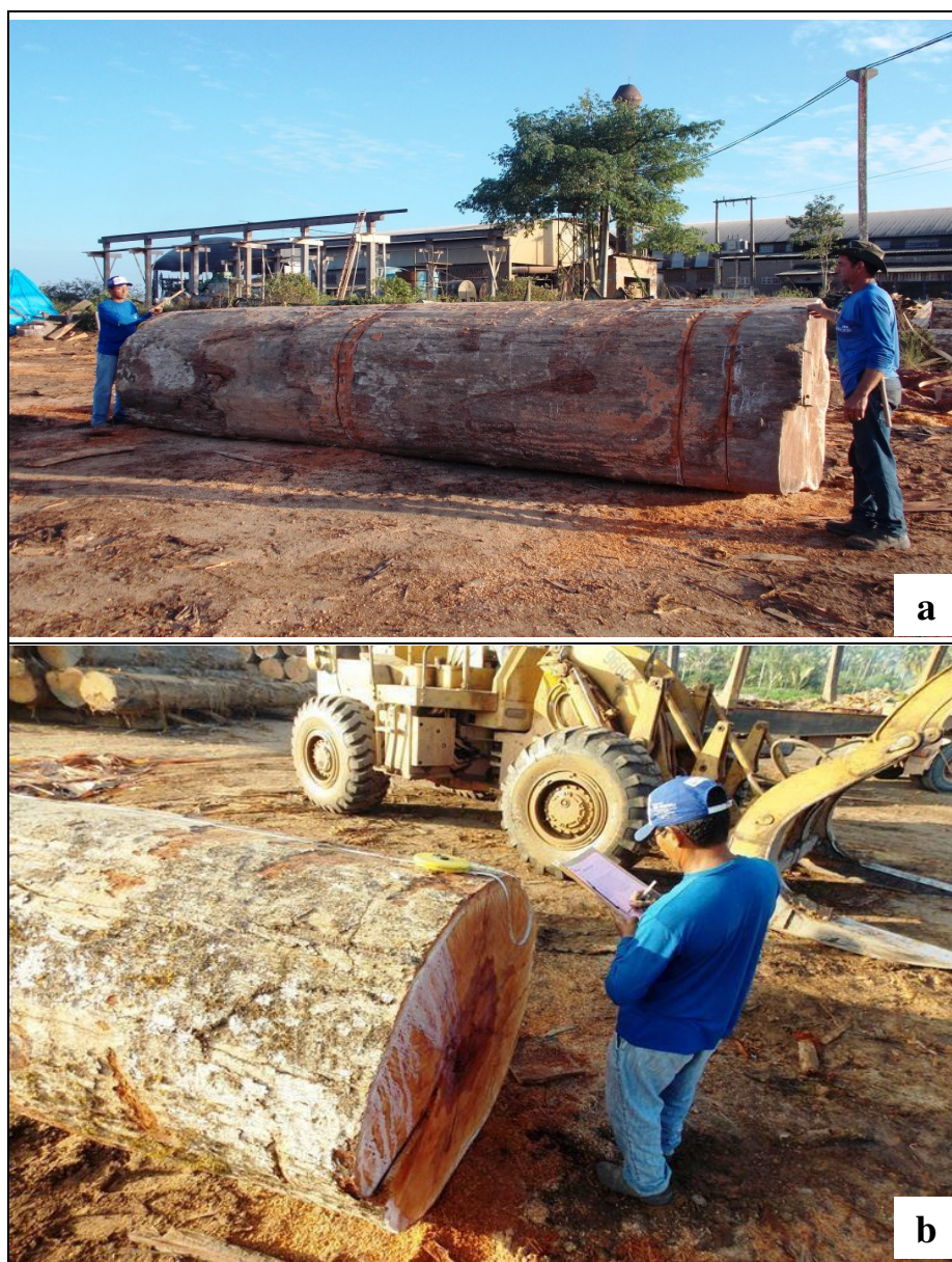
Figura 13 – a. Mensuração das toras no pátio de estocagem da empresa; b. anotação dos valores das mensurações no romaneio de toras.
