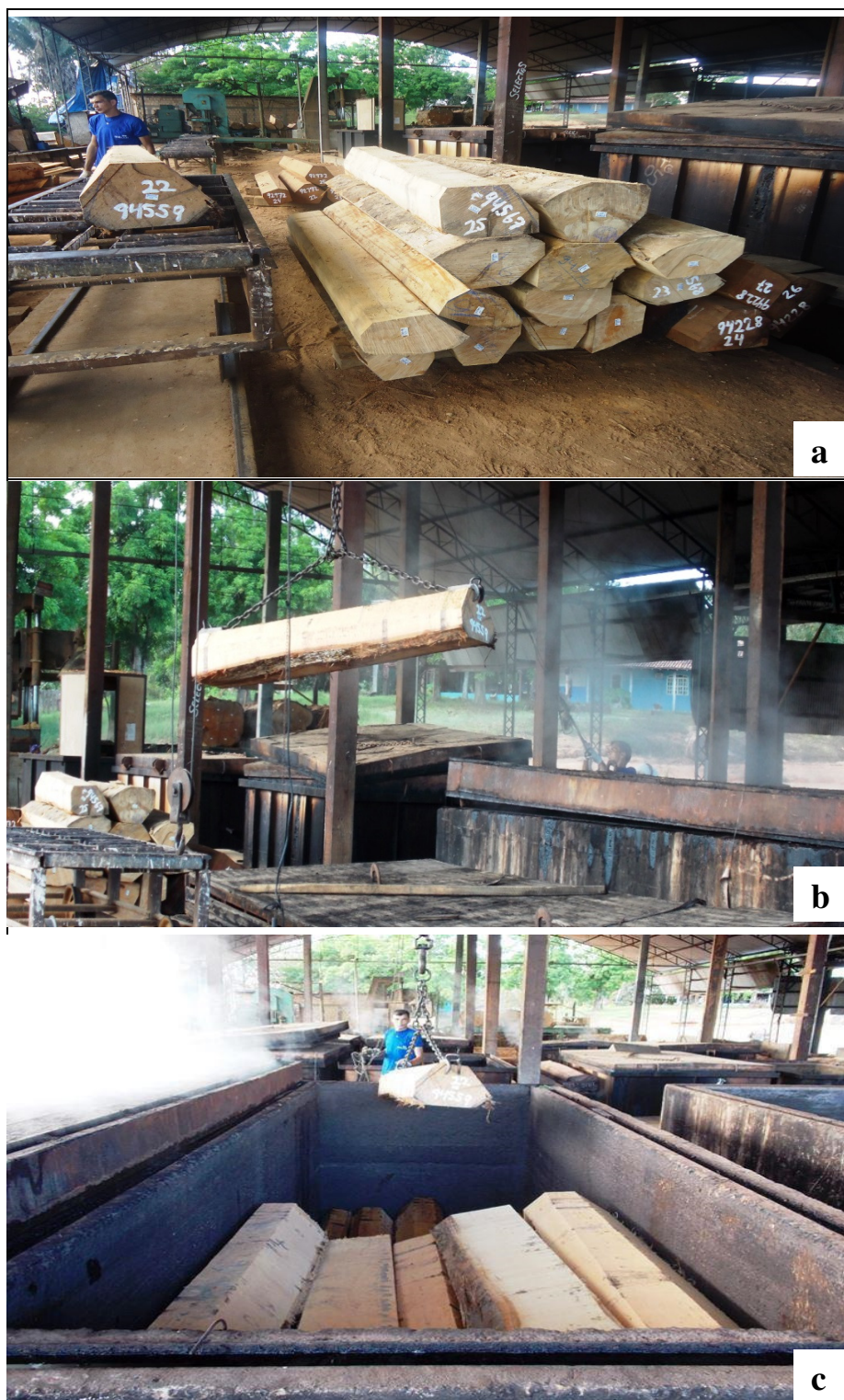
Figura 18 – a. Blocos definidos para o cozimento; b. Bloco transportado para o cozimento; c. Blocos no tanque de cozimento
