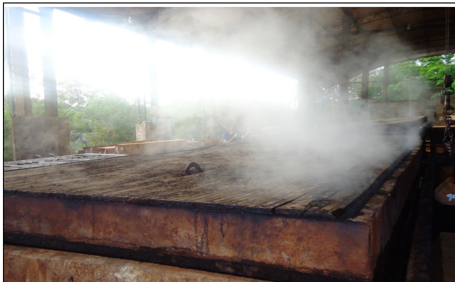
Figura 19 – Tanque fechado com madeira em cozimento a uma temperatura no interior do tanque variando entre 90° a 100° C
