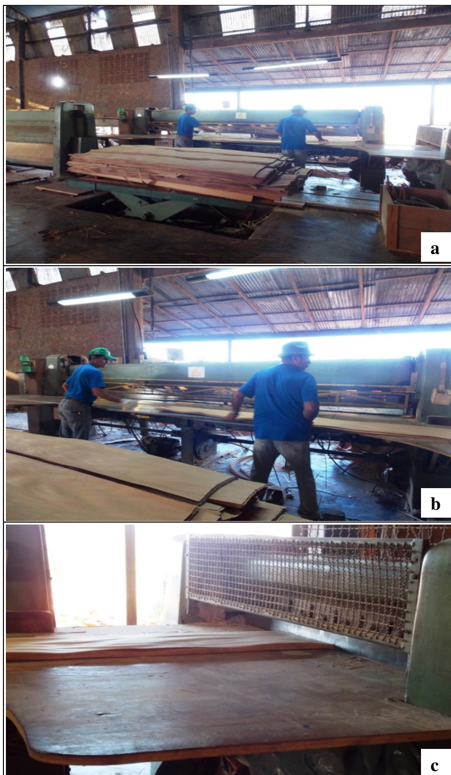
Figura 25 – a. Ajuste das lâminas para retirada das imperfeições laterais; b. Ajuste das lâminas para retirada das imperfeições das extremidades; c. Visualização do corte das extremidades.
