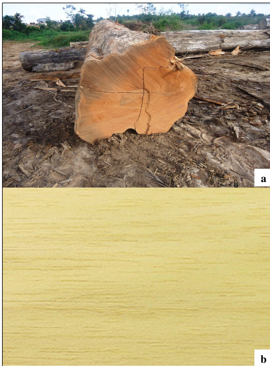
Figura 7 - Espécie tauari: a. Tora; b. Lâmina
