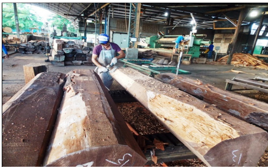
Figura 20 – Blocos plainados com plainas portáteis gerando resíduos sólidos denominados de cavacos
