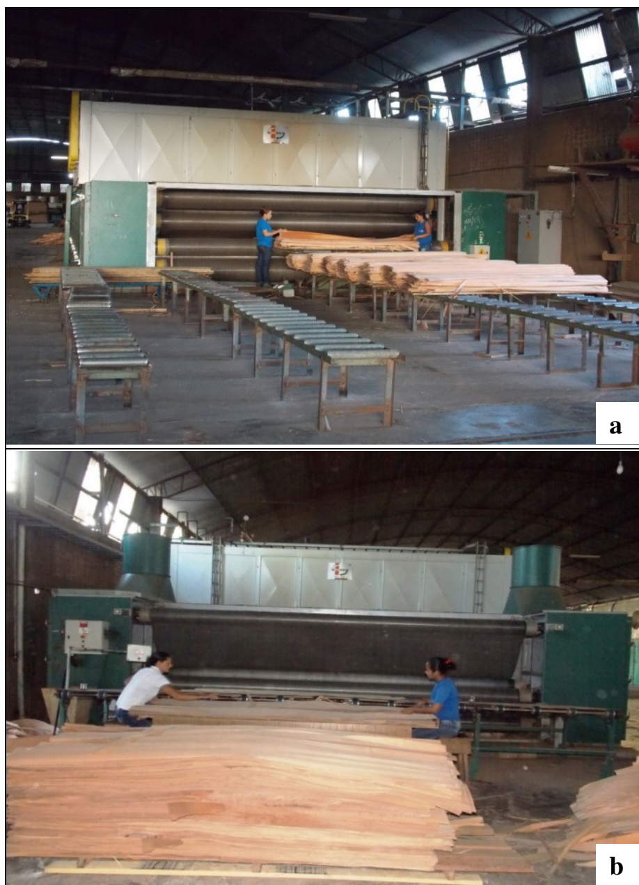
Figura 24 – a. Entrada das lâminas de madeira úmidas no secador; b. Saída das lâminas de madeira secas para guilhotinagem
