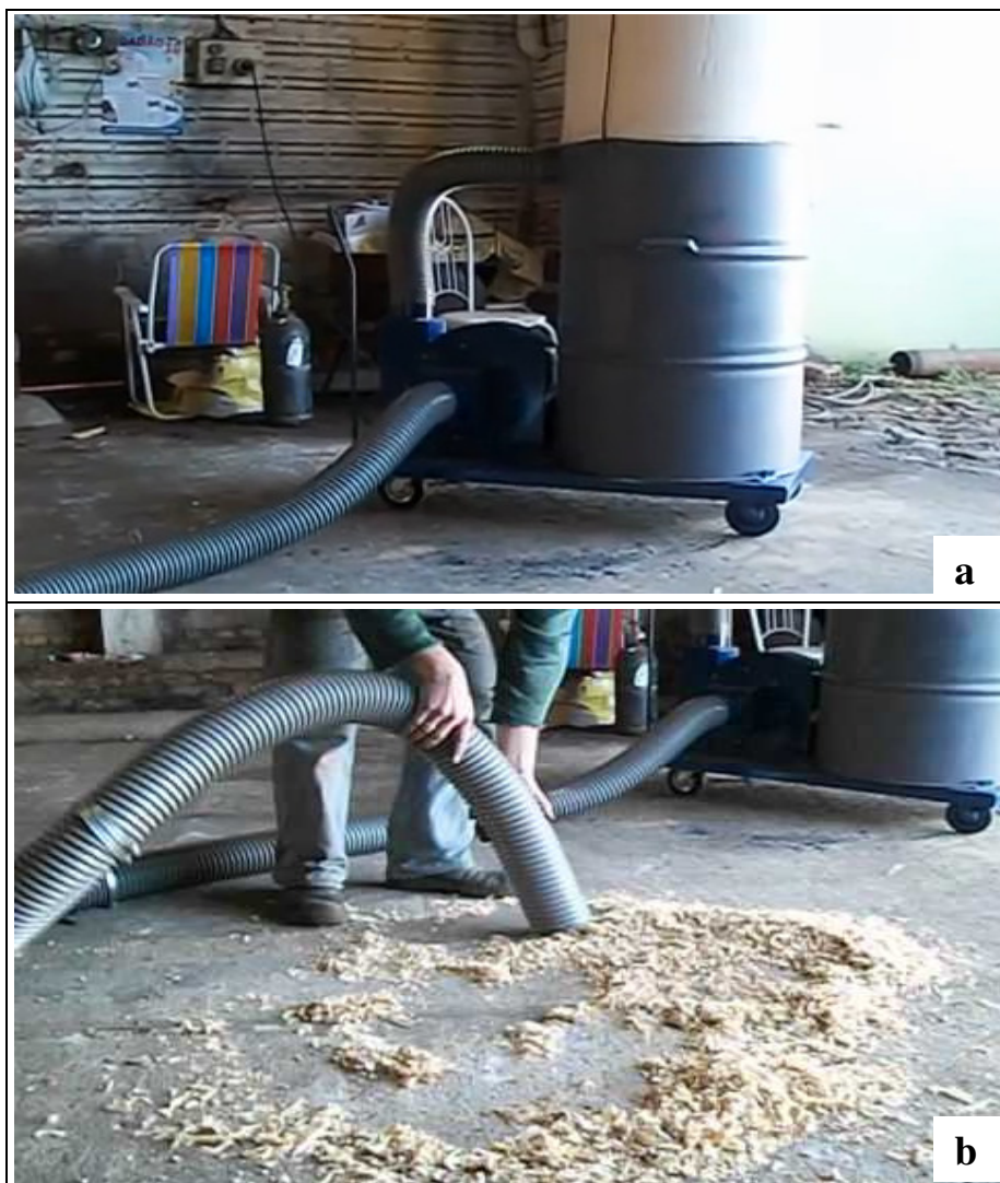
Figura 8 – a. Tambor metálico de aspiração; b. Realização da aspiração de serragem
