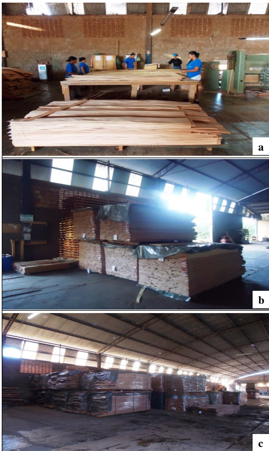
Figura 26 – a. Classificação das lâminas; b. pacotes etiquetados; c. pacotes prontos para expedição
