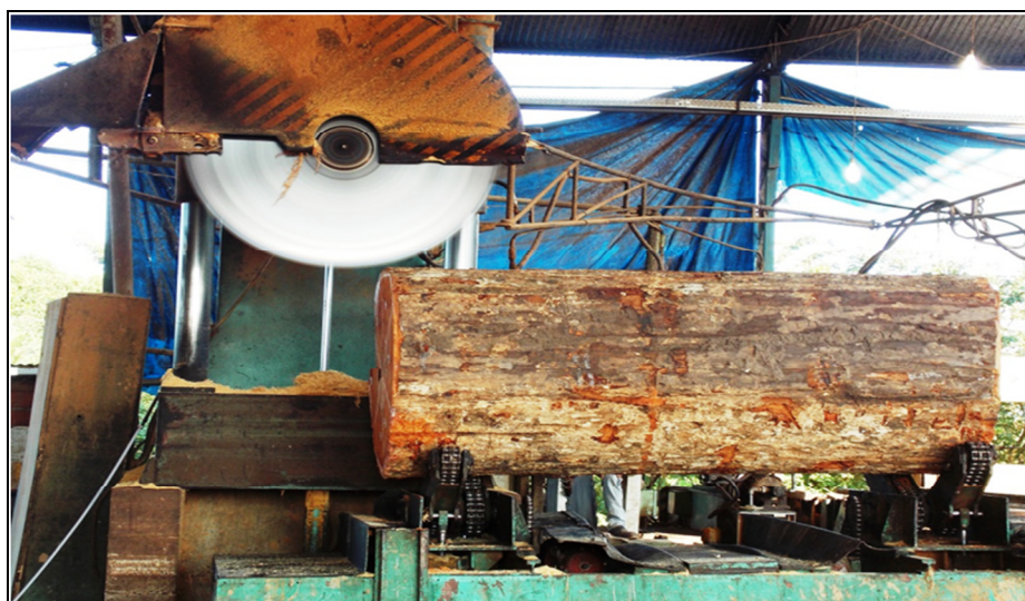
Figura 16 – Toras seccionadas pela serra circular radial na formação de blocos ainda não definidos seguindo o tipo de corte e desenho desejado pela empresa
