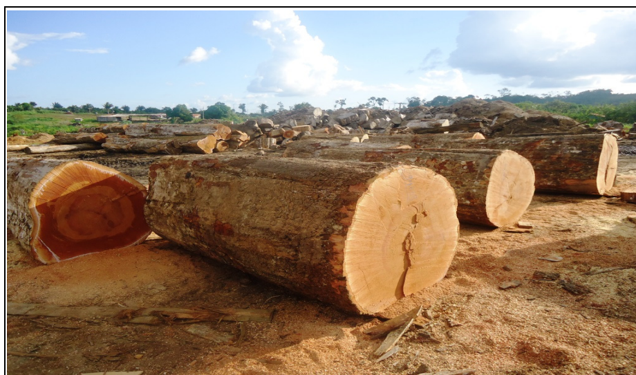
Figura 15 – Toras seccionadas que seguirão para serra circular radial
