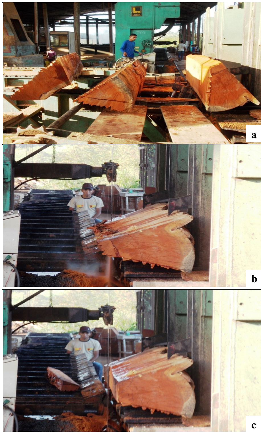
Figura 17 – a. Formação de blocos ainda não definidos na serra de fita; b. Retirada das costaneiras; c. Retirada das primeiras tábuas defeituosas
