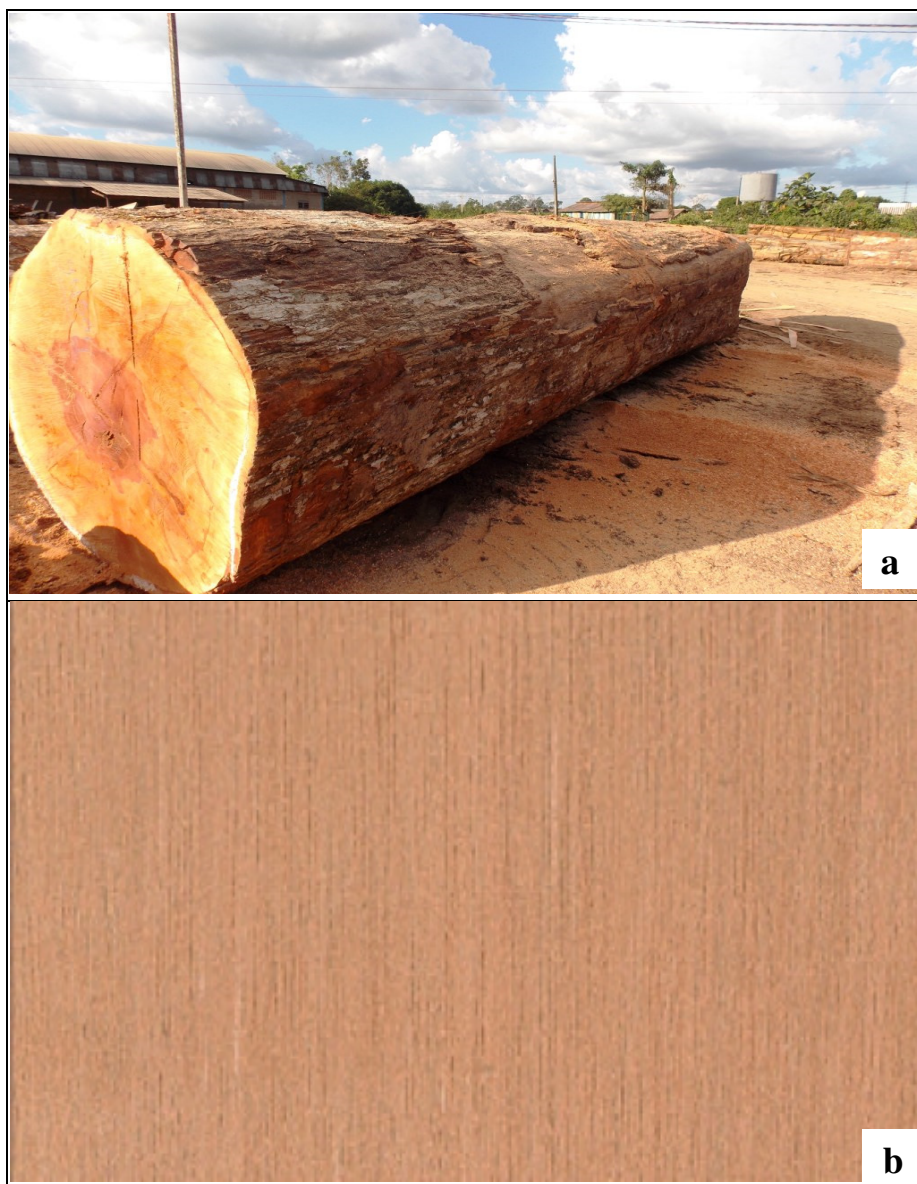
Figura 3 - Espécie curupixá: a. Tora; b. Lâmina
