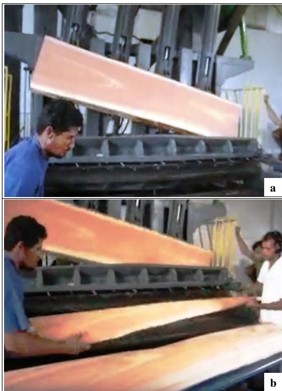
Figura 23 – a. Movimentação do bloco de madeira na posição vertical passando na faca; b. Obtenção das lâminas faqueadas de madeira
