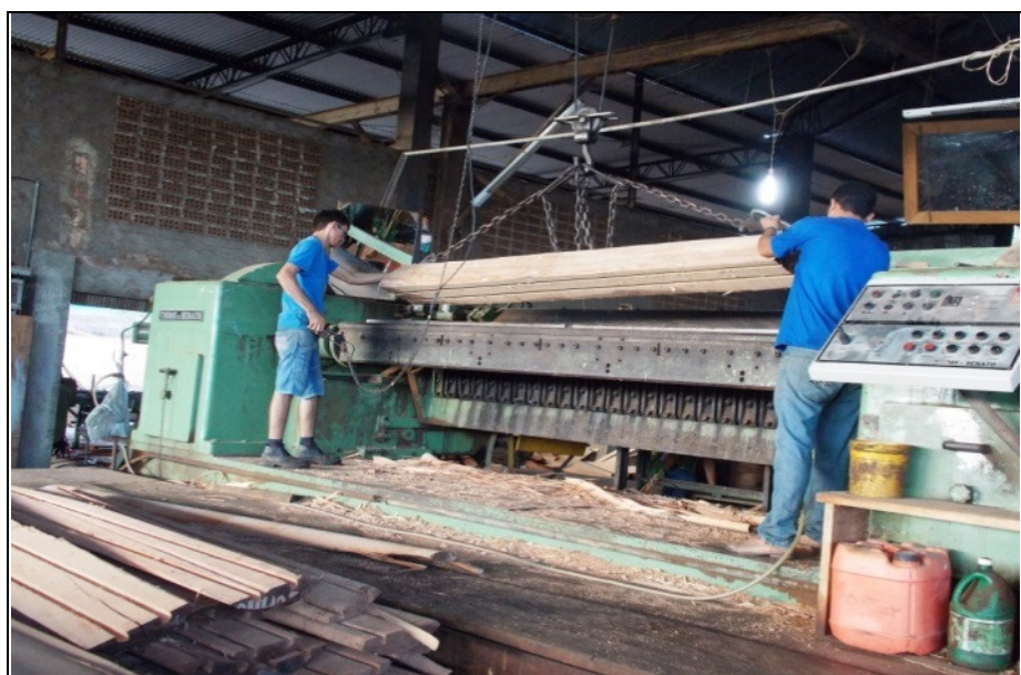
Figura 22 – Bloco plainado e fresado para ser fixado na faqueadeira
