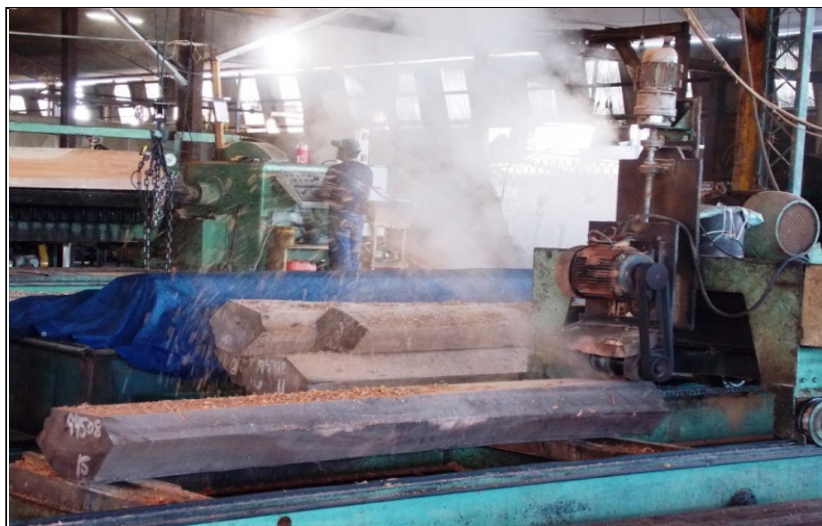
Figura 21 – Blocos plainados e fresados na máquina fresadora gerando resíduos sólidos denominados de cavacos
