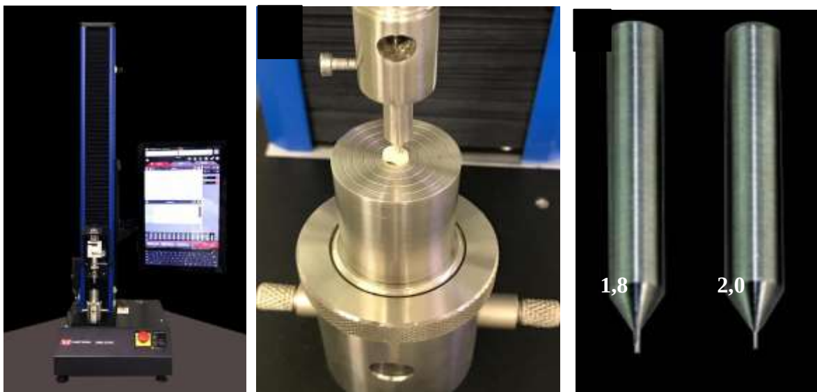
Figura 12. A - Máquina de ensaio universal Instron EMIC. B – Posicionamento da amostra para a realização do teste de push out . C – Hastes com o diâmetro usado no teste de push out .
