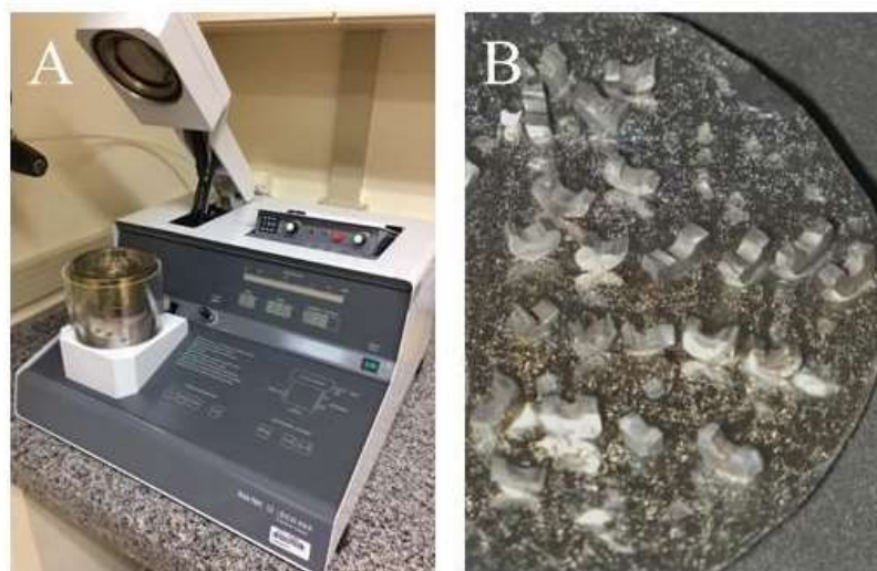
Figura 15. A - Metalizador. B – Amostras revestidas por ouro-pálido.
