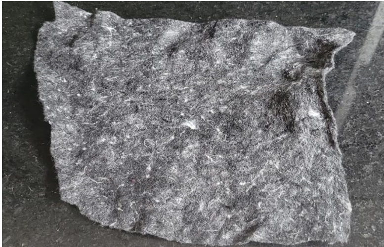
Figura 20 Amostra do Bidim® GT07 usado na pesquisa
