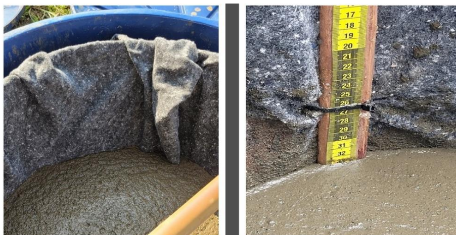
Figura 61 Filter cake e régua no reservatório de desaguamento
