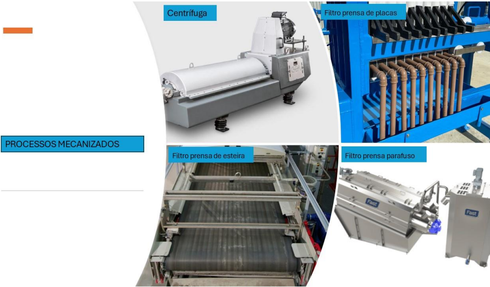
Figura 6 Tecnologias de desaguamento utilizando sistemas mecanizados
