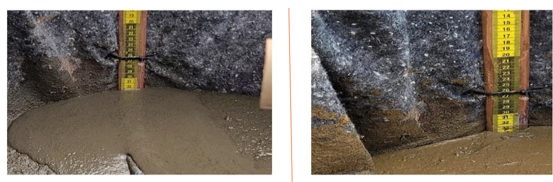
Figura 62 Altura inicial e altura final do ensaio de desaguamento - concentração 15,20 g/L SST
