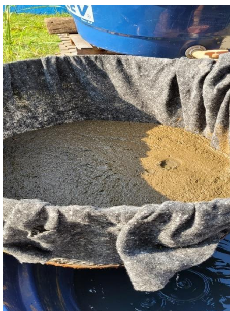
Figura 66 Filter cake formado no ensaio na estação piloto
