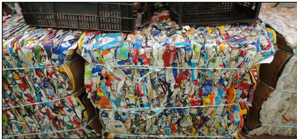
Figura 19 - Papel e papelão que foram separados e prensados e serão encaminhados para a reciclagem.
