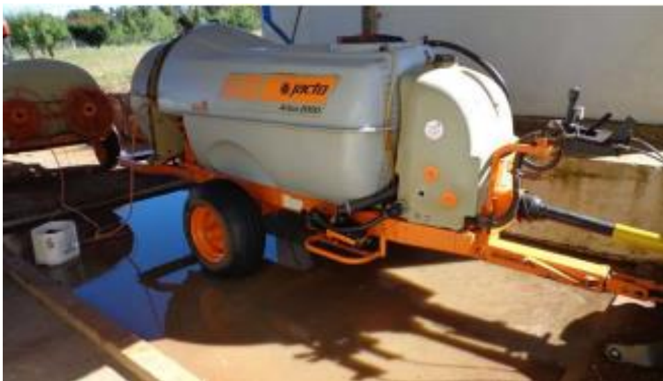
Figura 9 - Resíduos do ponto de abastecimento do pulverizador.
