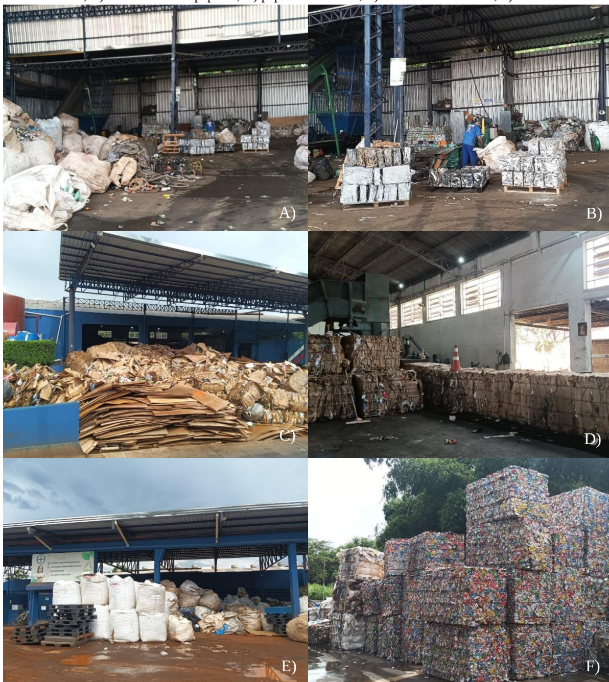
Figura 21 – Pátio de recebimento dos resíduos recicláveis: A) antes da triagem, B) após a triagem e enfardamento, C) recebimento de papelão, D) papeis enfardados, E) recebimento de latas, F) latas enfardadas.
