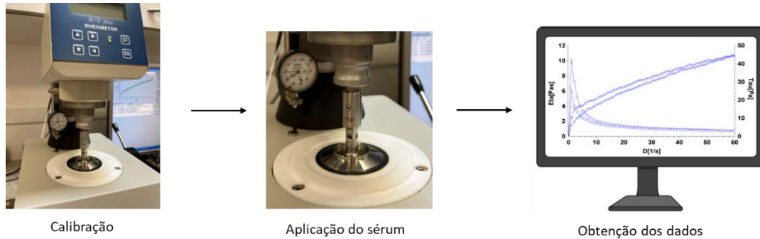
Figura 18. Representação esquemática do ensaio da avaliação reológica das formulações sérums e obtenção da viscosidade.
