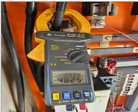
Figura 32 – Alicate Wattímetro utilizado pela Empresa Pública de Saneamento.
