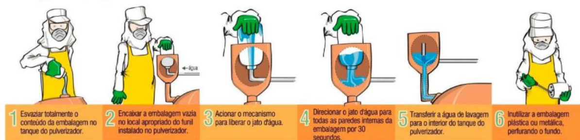
FIGURA 06: Demonstração da lavagem sob pressão das embalagens de agrotóxicos
