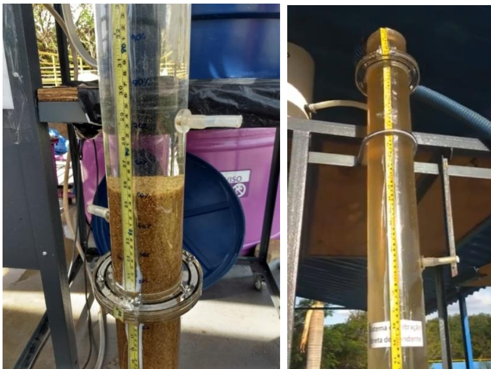
Figura 16 – Lavagem do filtro e expansão do leito durante a lavagem
