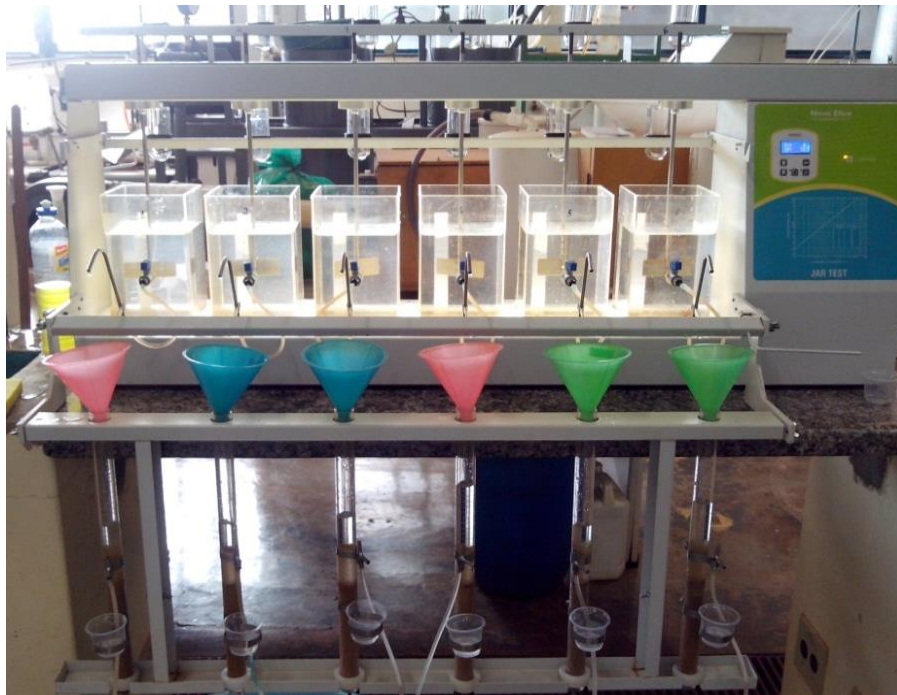
Figura 10 – Equipamento utilizado nos ensaios em bancada: jarteste e filtros de areia de laboratório
