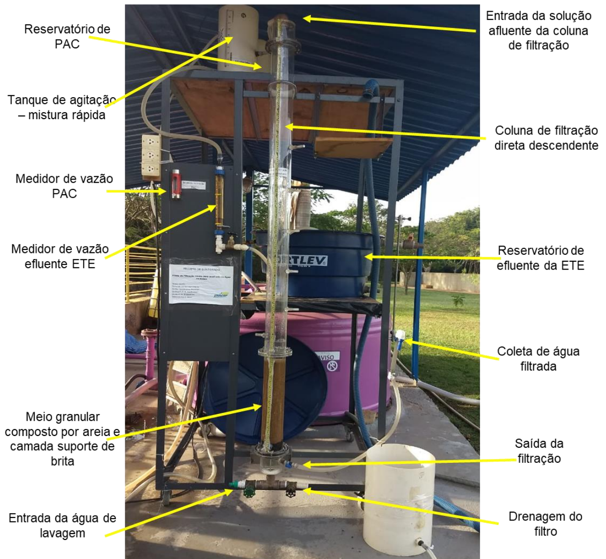
Figura 14 – Imagem da unidade piloto de filtração direta descendente na Estação de Tratamento de Esgoto Caiçara
