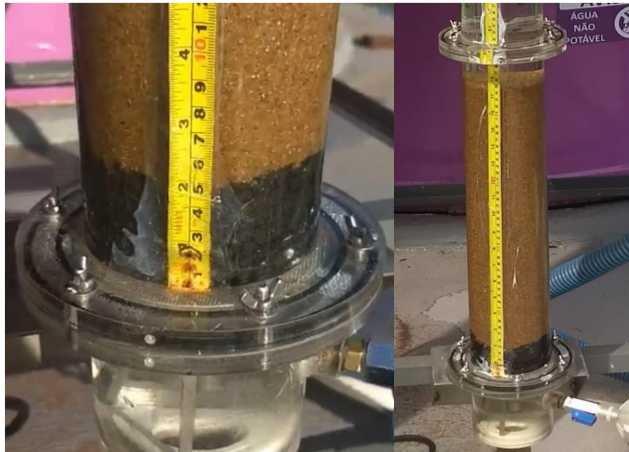
Figura 12 – Montagem do filtro de areia com meio suporte composto por brita e leito de areia
