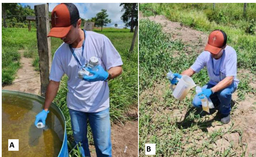
Figura 19- Coleta de água para ensaios microbiológicos e físico-químico (A) e armazenamento em frasco nasco (B).
