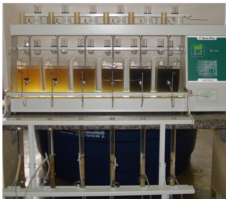
Figura 5.22: Foto do ensaio para verificação das condições de coagulação com o uso do CAP.
