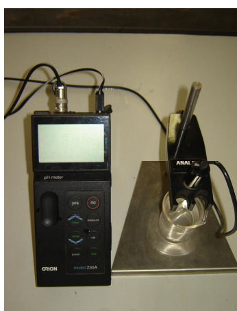
Figura 4.4: Potenciômetro (ORION – 230 A)
