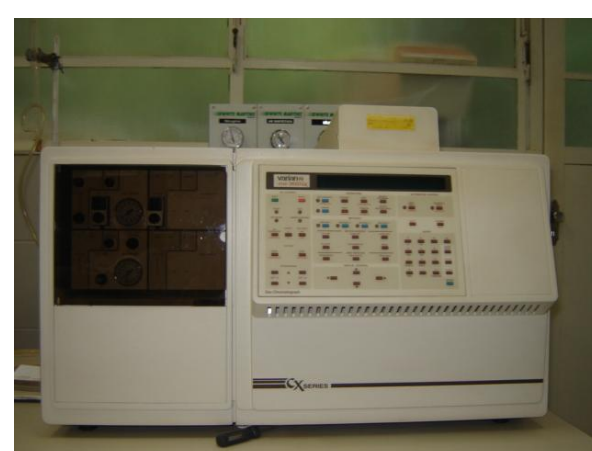
Figura 4.11: Cromatógrafo Gasoso VARIAN (STAR 3600 CX)
