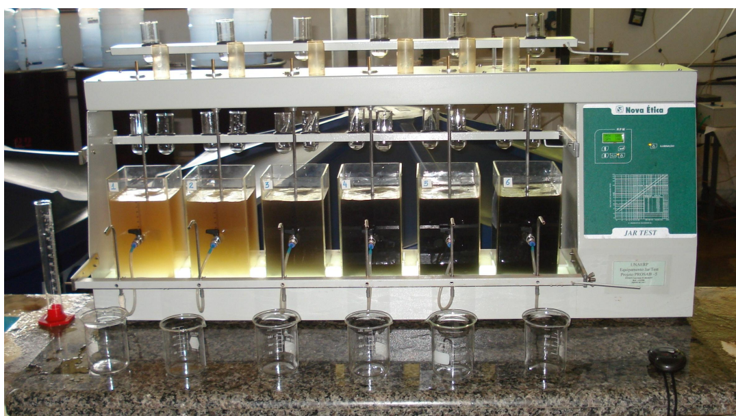
Figura 5.20: Foto de um ensaio de adsorção em CAP.
