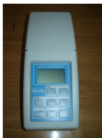
Figura 4.5: Turbidímetro (HACH – 2100 P)
