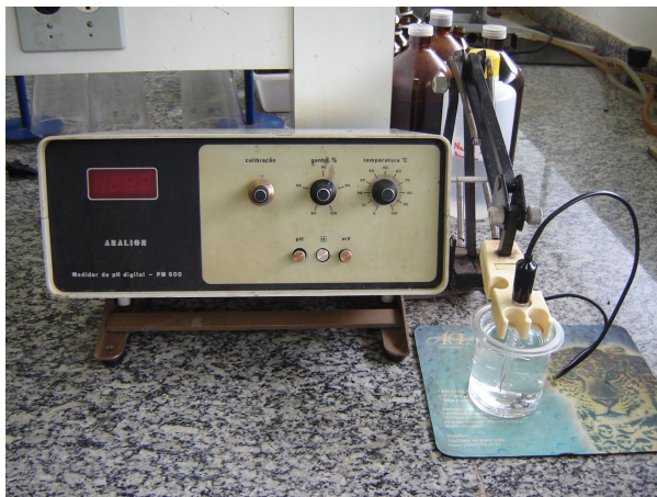
Figura 4.6: Potenciômetro (ANALION – PM 600)
