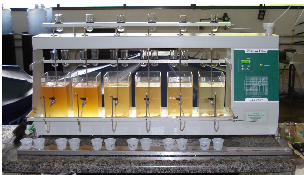
Figura 5.13: Foto de ensaio para otimização de dosagens (dosagem coagulante x pH coagulação) e construção dos diagramas de coagulação para o sulfato de alumínio.
