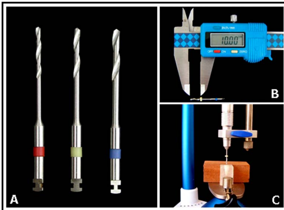
Figura 4 – A) Brocas do Kit do pino de fibra-de-vidro Fibrekor Post com parte ativa de 1mm de diâmetro (vermelha), 1,25 mm (amarela), 1,5 mm (azul); B) Aferição do comprimento da parte ativa da broca com paquímetro digital; C) Peça de mão acoplada ao paralelômetro para realização do preparo do conduto radicular.
