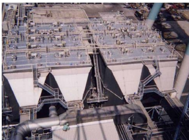
Figura 21. Exemplo de precipitadores eletrostáticos utilizados no tratamento de gases provenientes de uma caldeira a carvão
