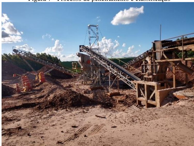
Figura 7 - Processo de peneiramento e classificação
