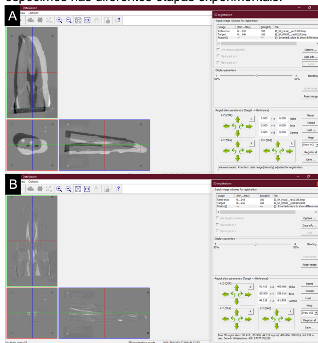
Figura 10. Ferramenta co-registration no programa DataViewer (A) antes e (B) após o alinhamento dos espécimes nas diferentes etapas experimentais.
