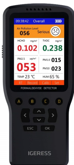
Figura 12 – Equipamento EGVOC-180 usado como detector de QAI no arquivo do cartório
