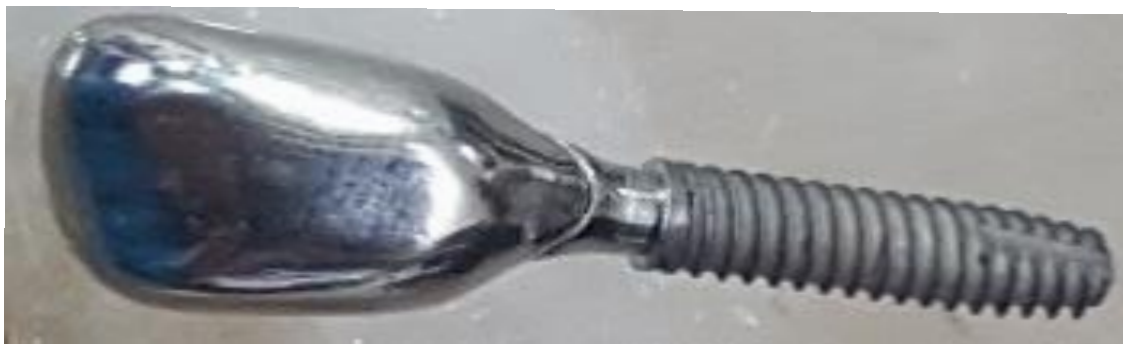
Figura 6: Coroa metálica cimentada em seu respectivo conjunto implante/pilar.
