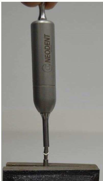
Figura 5: Instalação do pilar protético sobre o implante do G2,8 friccional com o martelete da Neodent.
