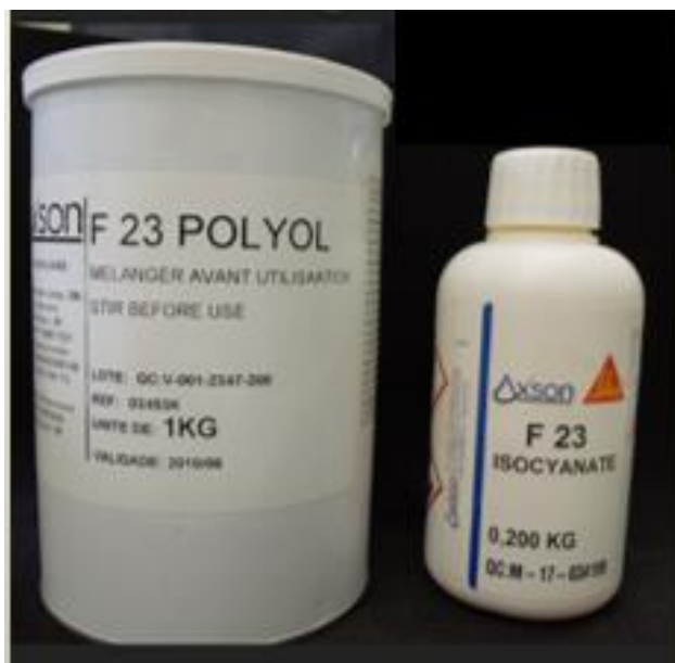
Figura 8: Resina Axson F23 Polypol (monômero e polímero) utilizada para o embutimento dos conjuntos.
