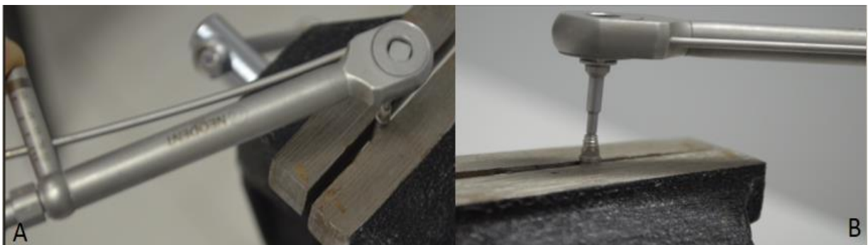
Figura 4: Instalação dos pilares protéticos e parafuso prolongador sobre os respectivos implantes: A e B) Aplicação do torque recomendado pelo fabricante com catraca manual. Vista superior (A) e vista lateral (B).
