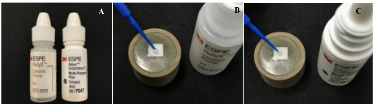
Figura 9. (A) Sistema adesivo - silano e catalisador, (B) aplicação do silano sobre o bloco de Y-TZP, (C) aplicação do catalisador do sistema adesivo sobre o bloco de Y-TZP
