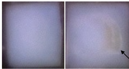
Figura 15. Tipos de falhas encontradas: (A) falha adesiva (B) falha mista. Seta preta identifica material resinoso aderido à superfície da Y-TZP.
