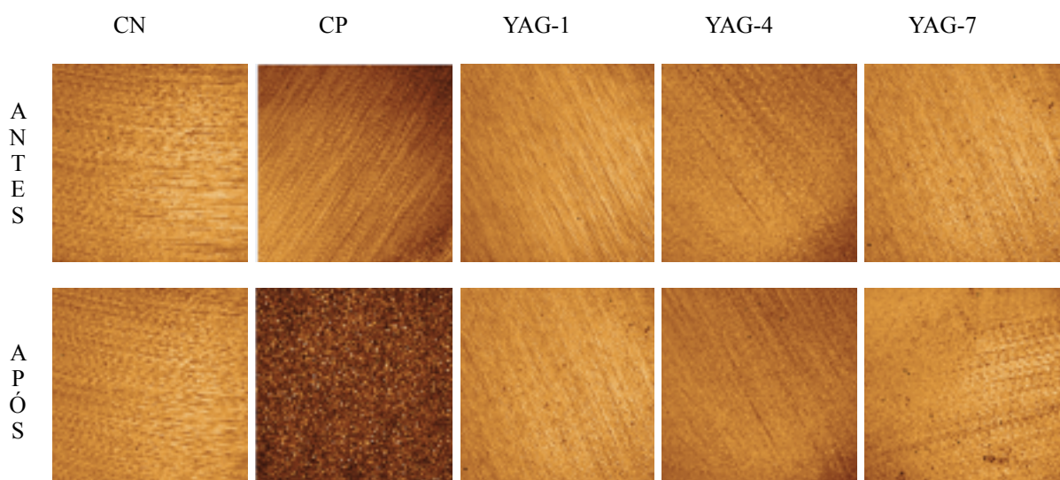
Figura 12. Fotomicrografias, obtidas por meio de microscopia confocal a laser, evidenciando morfologia de superfície da Y-TZP antes e após os tratamentos superficiais ( 5 \times )
