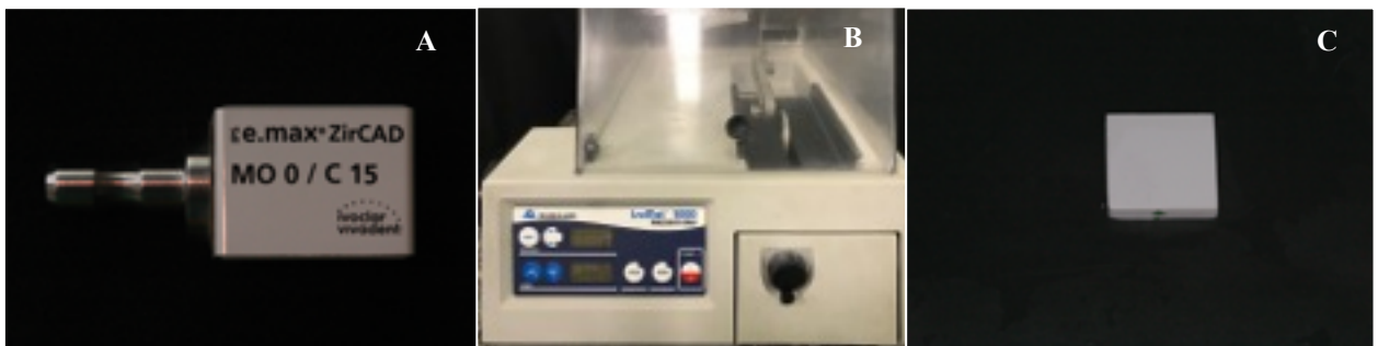
Figura 2. Obtenção dos blocos cerâmicos: (A) bloco cerâmico de zircônia (Y-TZP), (B) secção dos blocos, (C) bloco seccionado com dimensões de 7,0 mm de comprimento \times 6,5 mm de largura \times 4,0 mm de espessura.
