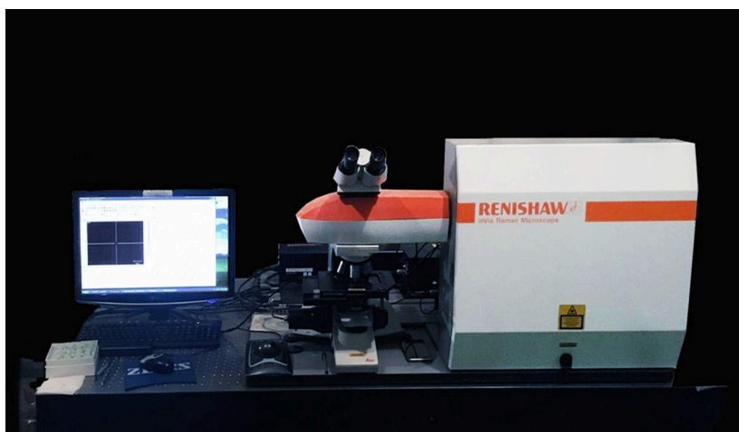
Figura 11: Microscópio Raman acoplado ao Microscópio Ótico e detector CCD.
