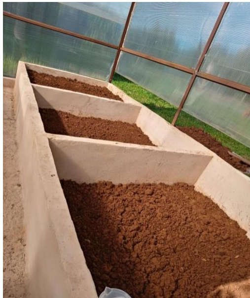
Figura 40. Vista do terceiro dia de exposição do lodo à secagem na estufa em estudo
