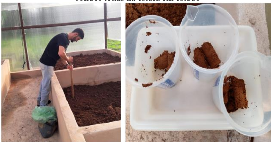
Figura 17. Coleta de amostras de lodo nos leitos para determinação da concentração de sólidos totais na estufa em estudo
