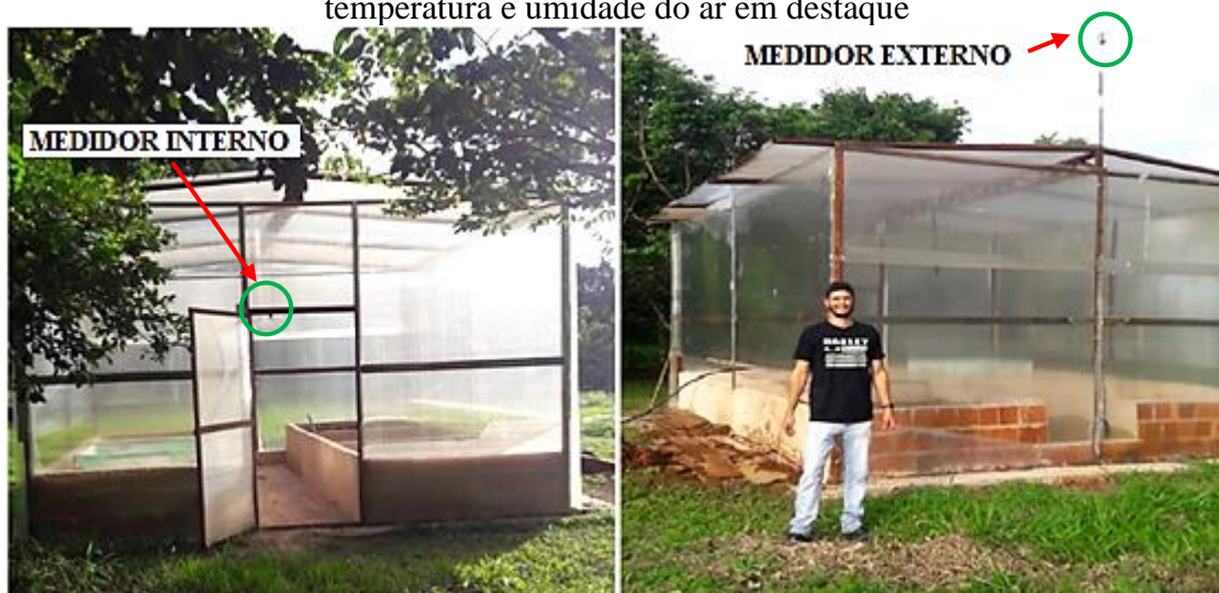
Figura 31. Estufa piloto para secagem natural de lodo de ETA e a localização do medidor de temperatura e umidade do ar em destaque
