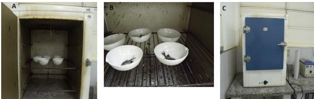
FIGURA 8: Secagem dos peixes em estufa. A: Interior da estufa para secagem dos peixes, B: Cadinhos com os peixes, C: Estufa para secagem dos peixes – vista geral.
