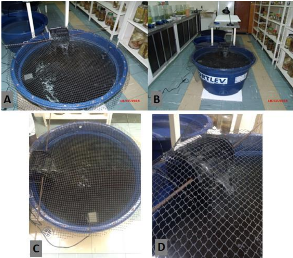
FIGURA 3: Caixas para a realização do experimento. A: Caixa de polietileno FORTLEV para 150 L B: Preparação da tela de proteção, C: Caixa de polietileno com a tela, D: Sistema de fixação da tela protetora.
