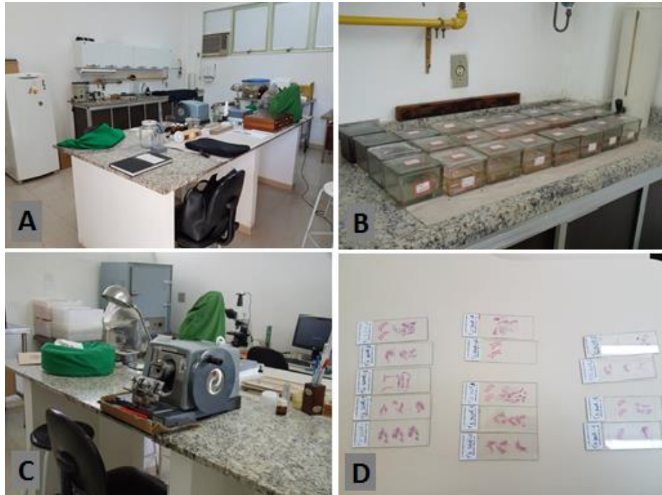
FIGURA 10: Laboratório de técnicas histológicas . A: Visão geral B: Bateria para processamento e coloração (HE), C: Micrótomo, D: Lâminas confeccionadas.
