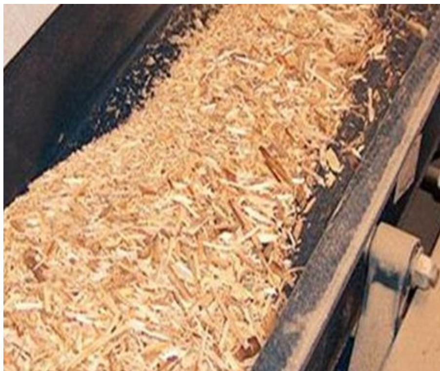
Figura 25 - Filetes de madeira picotados e transportados em uma esteira
