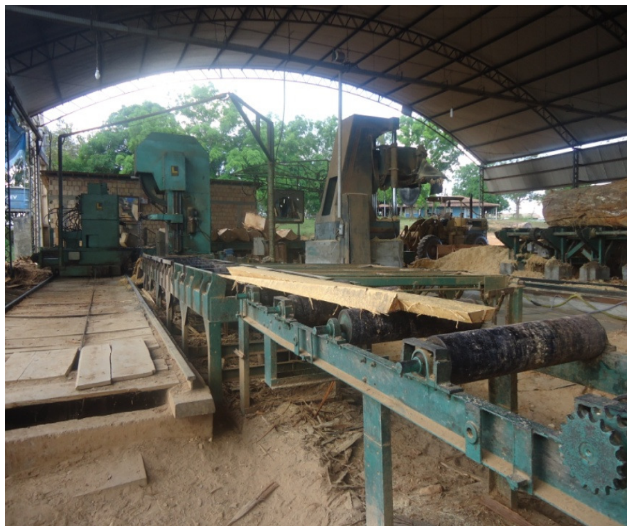
Figura 16 - Costaneiras produzidas pela serra de fita na formação de blocos não definidos na fabricação de lâminas faqueadas de madeira
