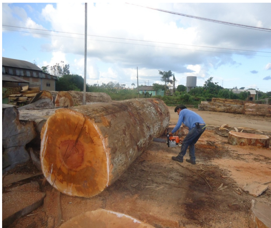
Figura 8 - Mensuração e seccionamento da madeira com motosserra realizado no pátio de estocagem da empresa no processo de produção de lâminas faqueadas
