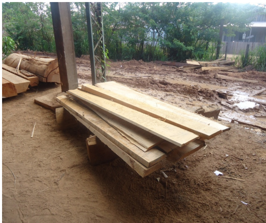
Figura 17 - Tábuas com defeitos produzidas pela serra de fita na formação de blocos ainda não definidos do processo de produção de lâminas faqueadas de madeira
