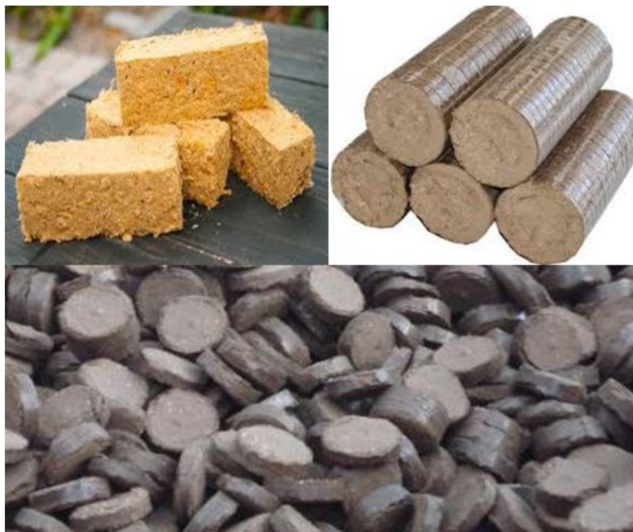
Figura 31 - Formatos de briquetes de serragem em formas retangulares, cilíndrica e a granel
