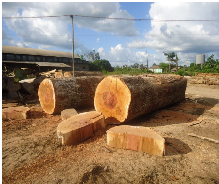
Figura 9 - Destopos de toras e serragem gerados no processo mensuração e seccionamento da empresa em estudo
