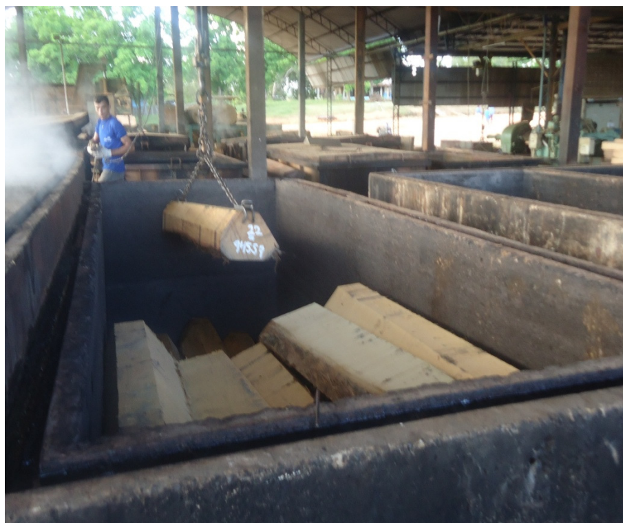
Figura 18 – Blocos sendo preparados e armazenados nos tanques de cozimento a uma temperatura no interior do tanque variando entre 90° a 100° C
