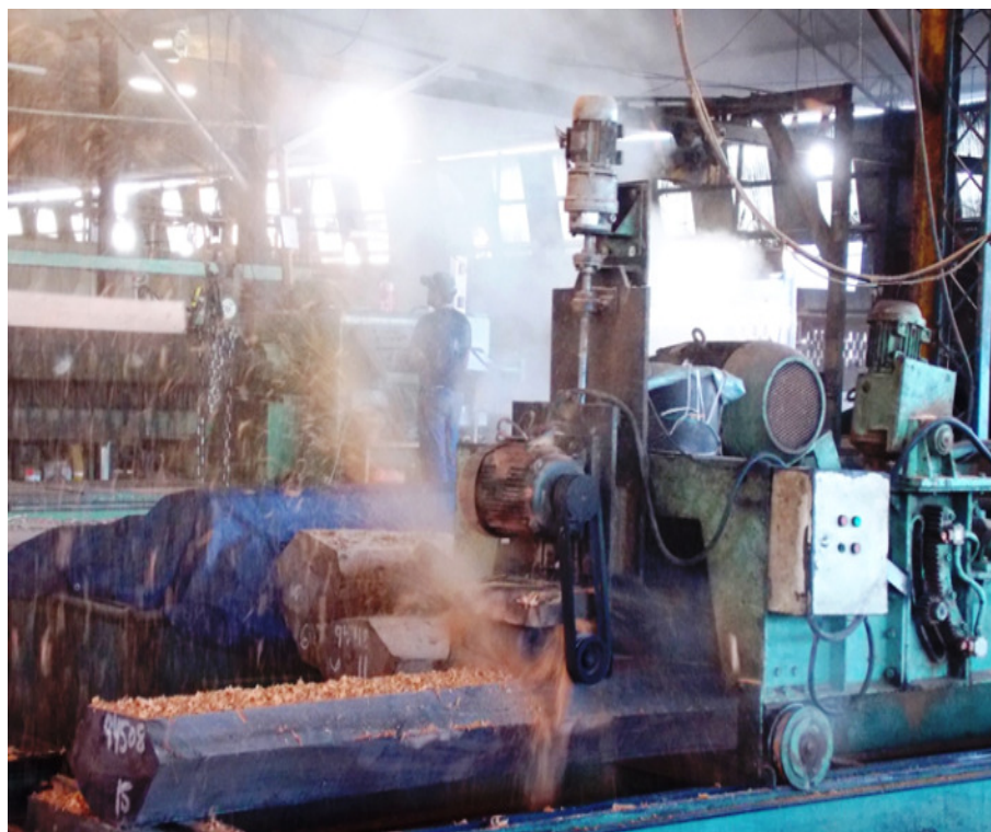
Figura 20 - Blocos fresados na máquina fresadora gerando resíduos sólidos denominados de cavacos na produção de lâminas faqueadas de madeira
