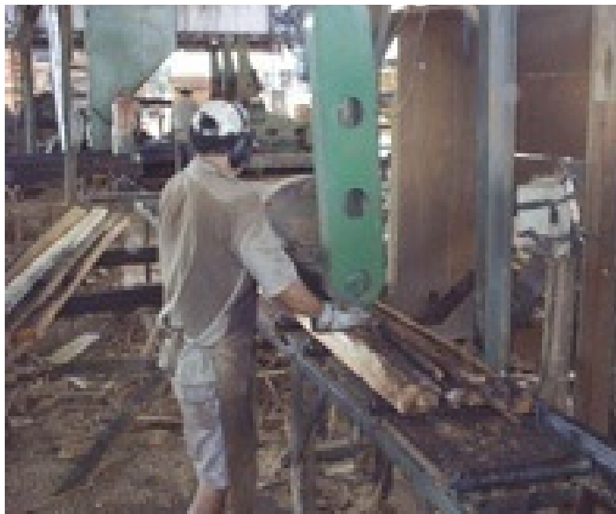
Figura 32 - Costaneiras sendo destopadas e refiladas para fabricação de quadradinhos em uma serra circular destopadeira
