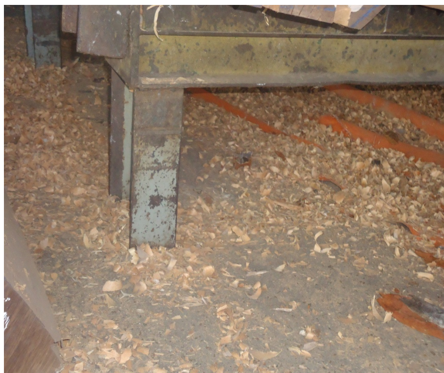
Figura 21 - Cavacos gerados pelo processo de plainamento e fresamento na produção de lâminas faqueadas de madeira
