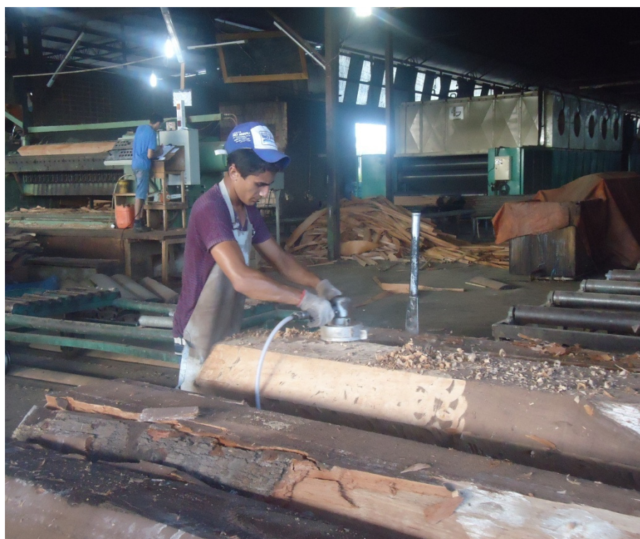
Figura 19 - Blocos plainados com plainas portáteis gerando resíduos sólidos denominados de cavacos na produção de lâminas faqueadas de madeira
