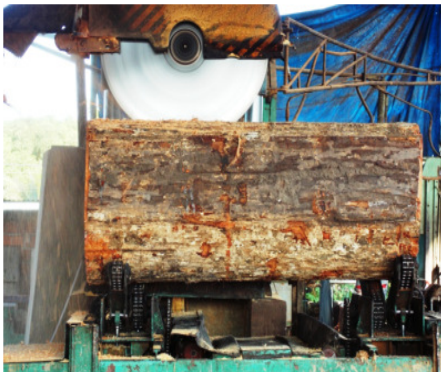
Figura 11 - Toras seccionadas pela serra circular radial na formação de blocos ainda não definidos seguindo o tipo de corte e desenho desejado pela empresa
