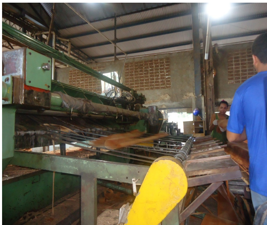
Figura 22 - Processo de laminação dos blocos na faqueadeira na produção de lâminas faqueadas de madeira
