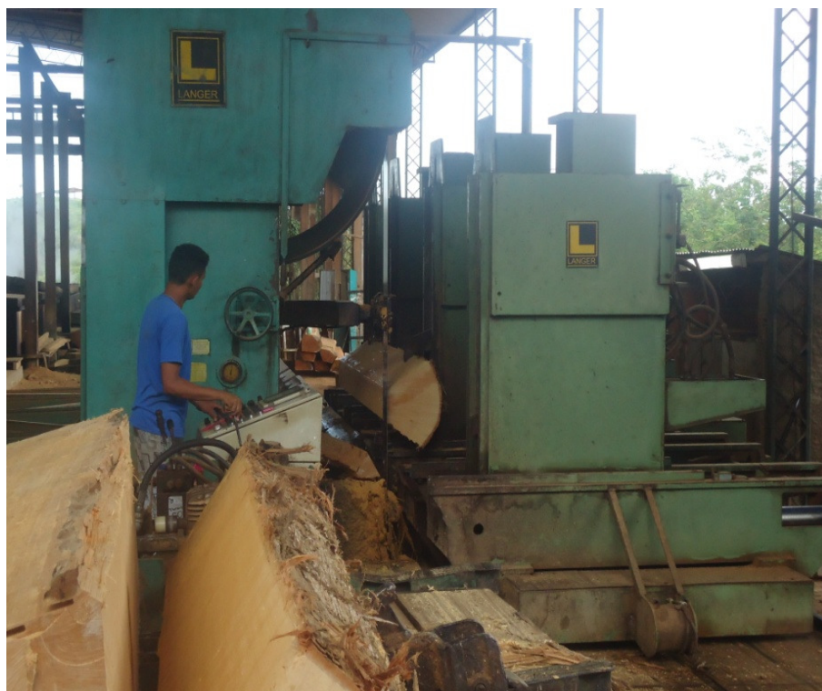
Figura 13 - Formação de blocos ainda não definidos na serra de fita onde são retirados os resíduos sólidos conhecidos como costaneiras
