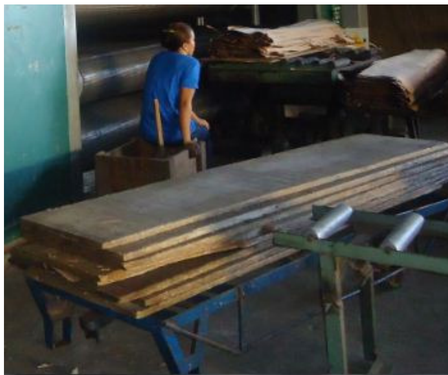
Figura 24 - Tábuas de aproveitamento dos blocos geradas na faqueadeira na produção de lâminas faqueadas de madeira
