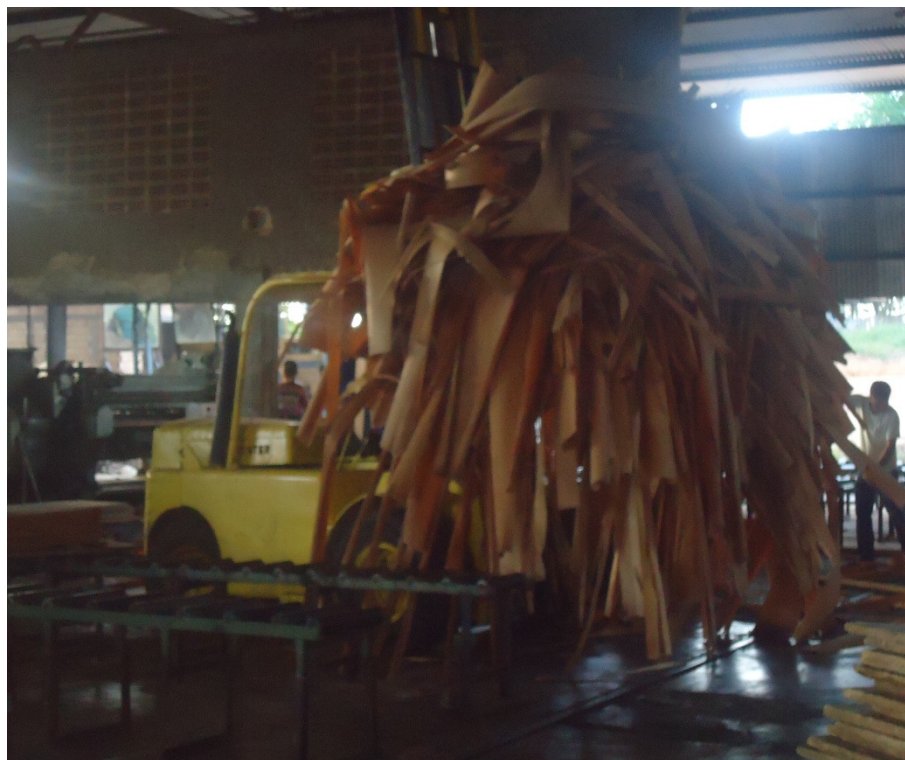
Figura 23 - Lâminas com defeitos geradas na faqueadeira transportadas na empilhadeira
