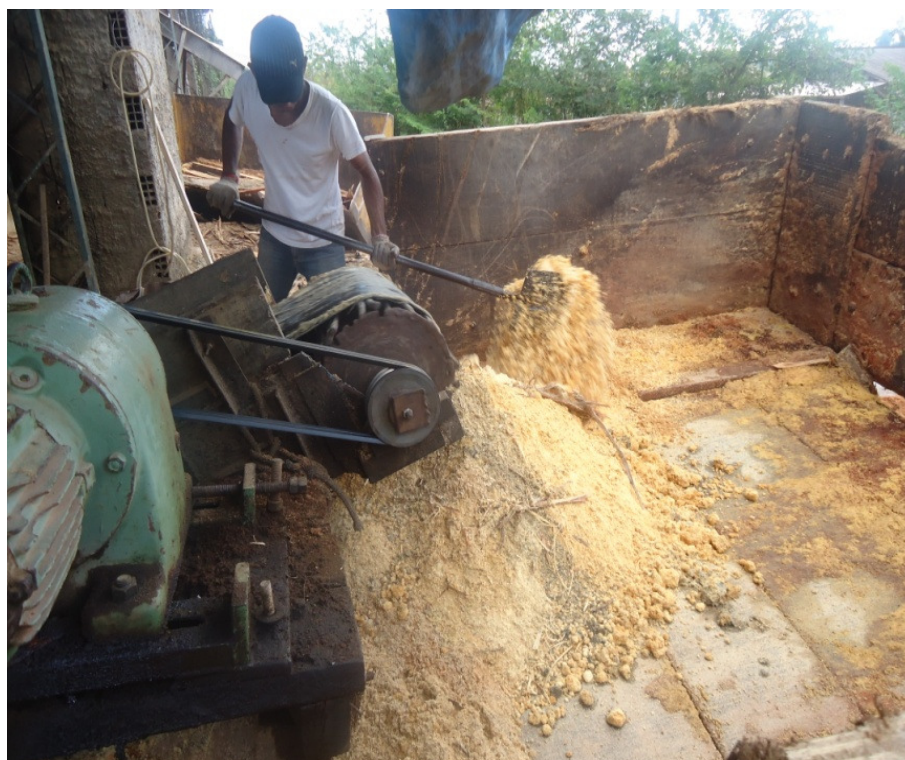
Figura 14 - Serragem produzida pela serra de fita armazenada em uma baía de madeira localizada próxima a serra sendo espalhada na baía por um colaborador da madeireira
