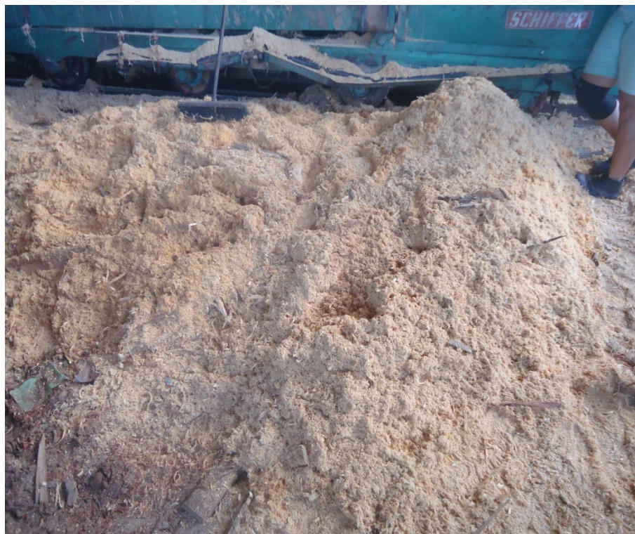
Figura 15 - Serragem produzida pela serra de fita amontoada próximo a serra de fita exposta no galpão de produção de lâminas faqueadas de madeira
