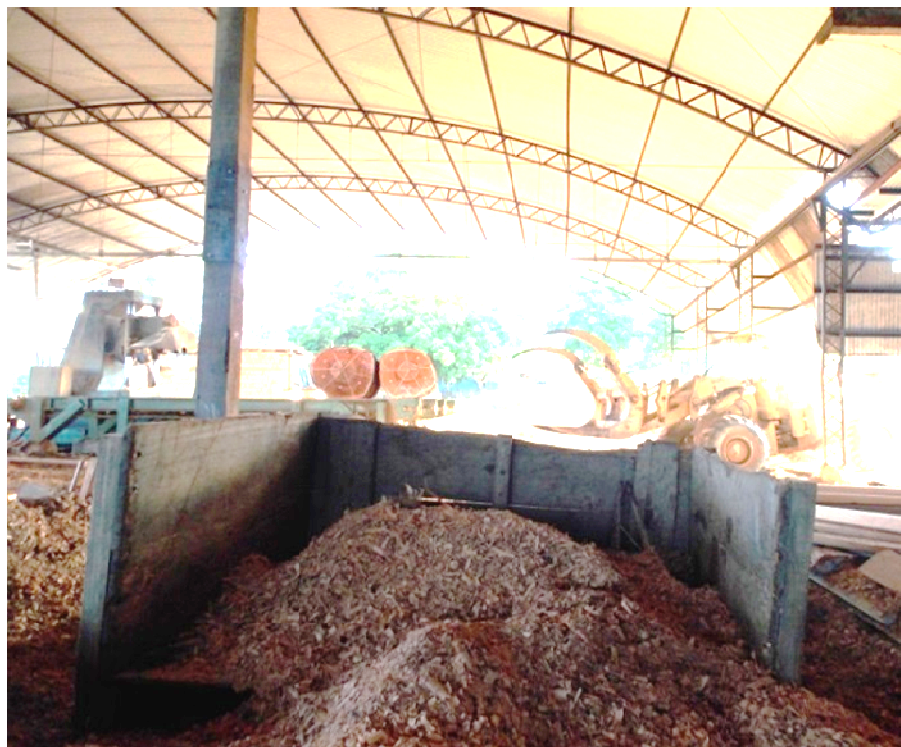
Figura 12 - Serragem produzida pela serra circular radial armazenada em uma baia de madeira localizada próximo a serra
