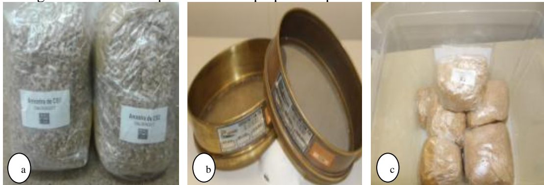
Figura 14. Armazenamento de Agroresíduos de Soja: a) amostras in natura secas a peso constante; b) Peneiras para homogeneização de amostras; c) Amostras homogeneizadas secas a peso constante preparadas para o estudo da biomassa
