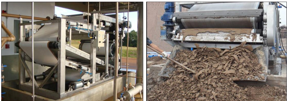
Figura 4: Foto de um equipamento filtro prensa de esteira
