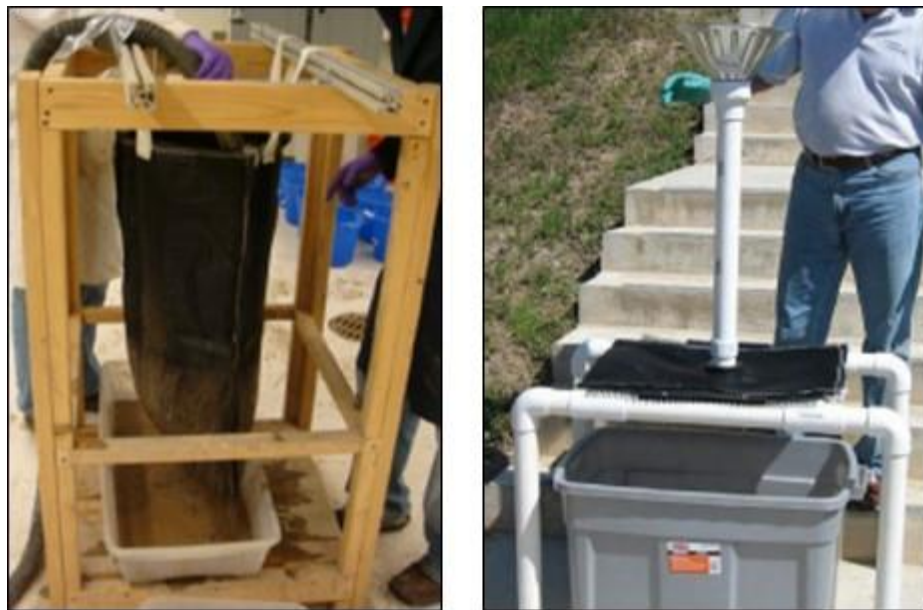
Figura 16: A esquerda teste de bolsa suspensa (HBT). A direita teste de bolsa de pequena dimensão (GDT)
