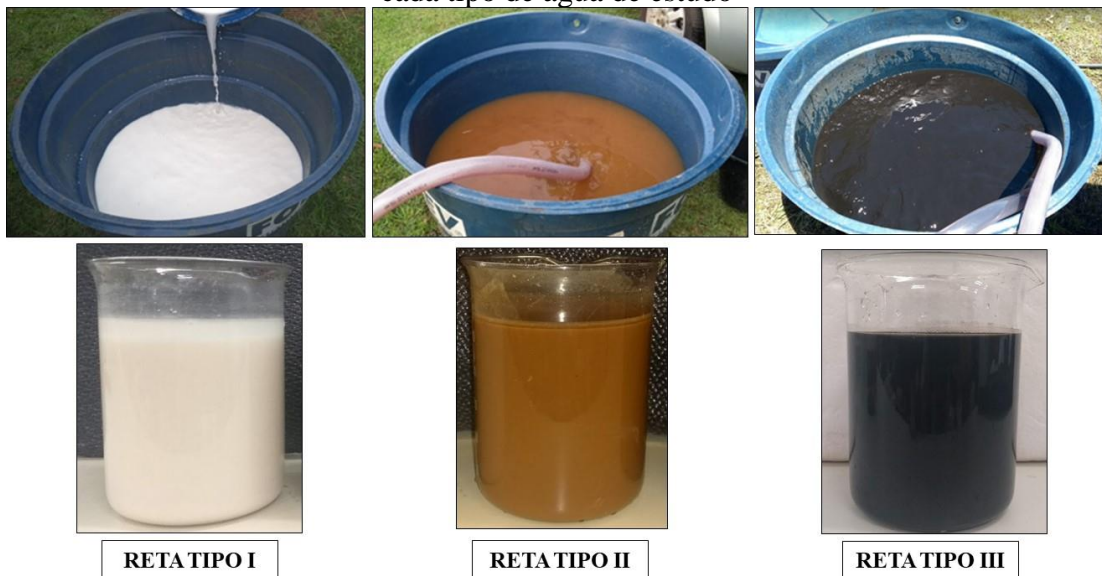
Figura 33: Imagens dos três tipos de resíduos de tratamento de água (RETA) gerados para cada tipo de água de estudo
