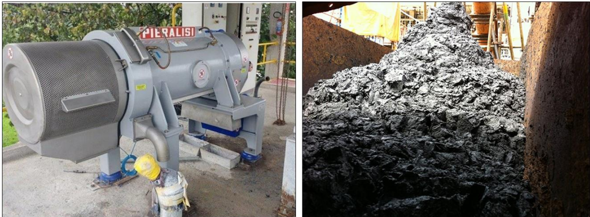
Figura 3: Imagem de uma centrífuga de desaguamento de RETA (esquerda) e o aspecto do resíduo já desaguado (à direita)
