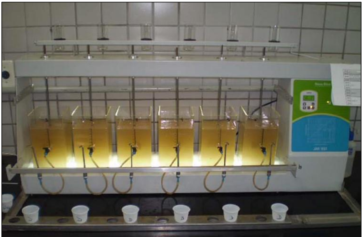
Figura 24: Equipamento de jarteste utilizado na pesquisa
