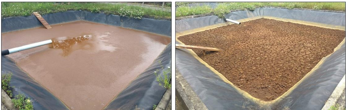
Figura 6: Foto do sistema de desaguamento de leito de drenagem/secagem
