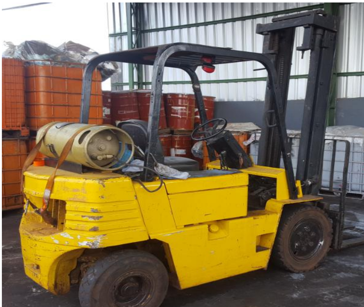
Figura 15: Empilhadeira para transporte, movimentação, armazenagem e manuseio de equipamentos e big bags para acondicionamento de resíduos
