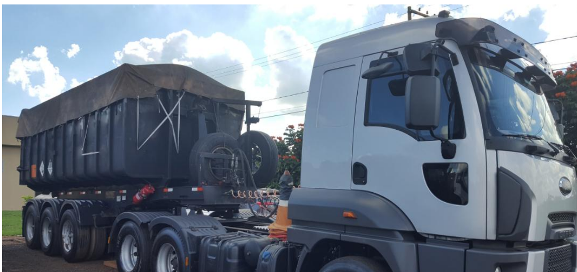
Figura 14: Caçamba com sistema roll-on-off existente na empresa do estudo
