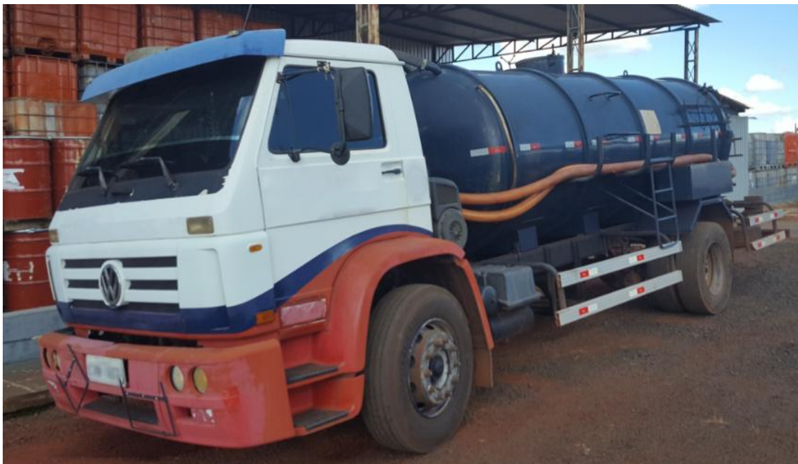
Figura 11: Caminhão tanque com sucção existente na empresa do estudo
