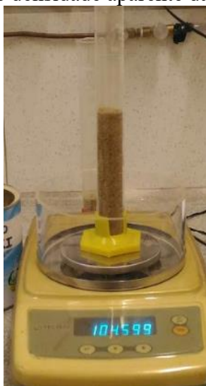
Figura 15 - Ensaio de densidade aparente da biomassa do abacaxi
