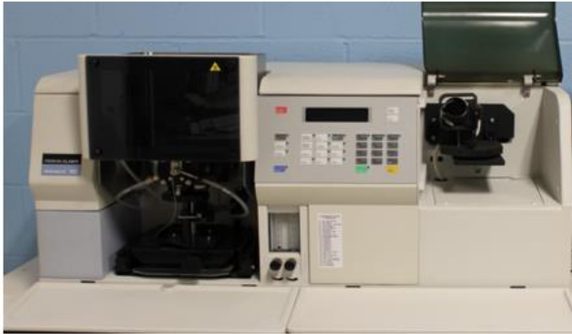
Figura 11 - Espectrofotômetro A Analyst 100 da Perkin Elmer e modelo de lâmpada de cátodo em detalhe
