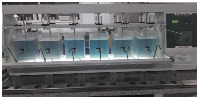
Foto tirada após adsorção antes da adição do alcalinizante e coagulante
