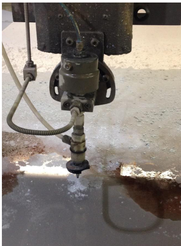
Figura 26 - Bico por onde sai o jato pressurizado de água e abrasivo
