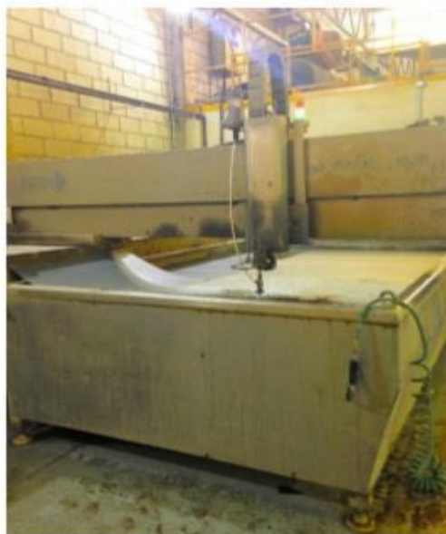
Figura 3 – Máquina Technos Prime de corte a jato de água e abrasivo
