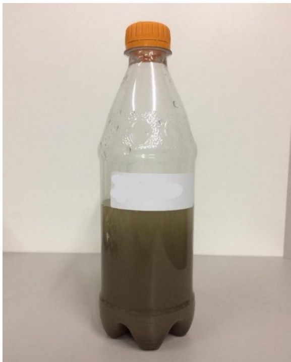
7 Figura 25 - Água proveniente do processo de corte
