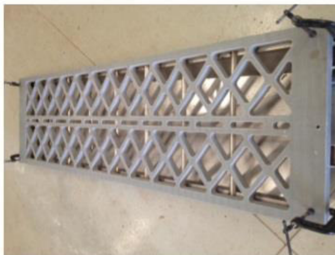
Figura 2 – Placa de UHMWPE Cinza beneficiada na máquina de corte a jato de água e abrasivo
