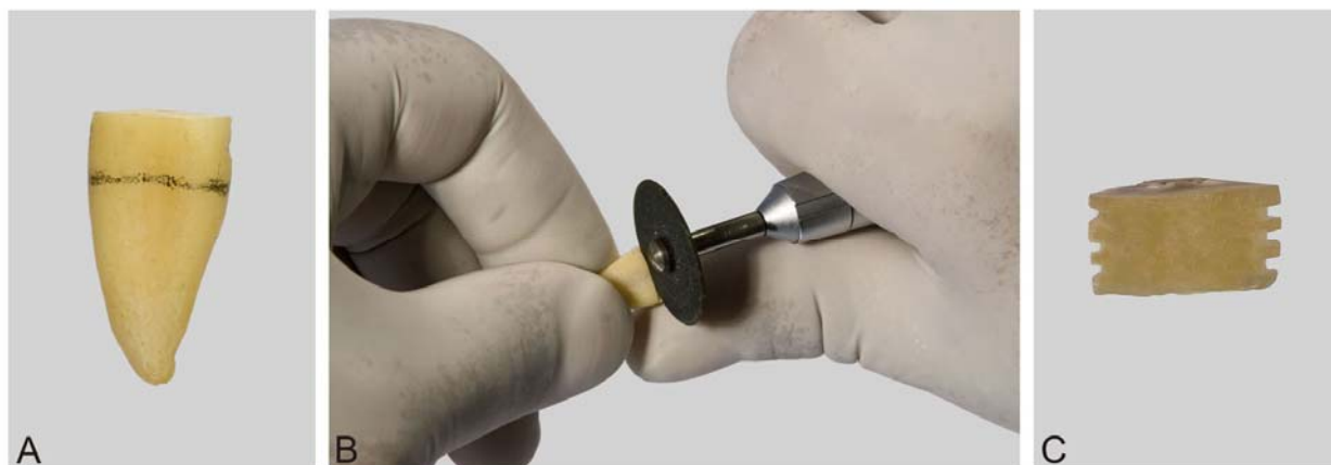
Figura 2. Sequência de preparo dos dentes. A) Raiz com demarcação da região da secção; B) Posicionamento do disco carborundum para secção da raiz; C) Cilindro de raiz com 5 mm de altura e ranhuras transversais.
