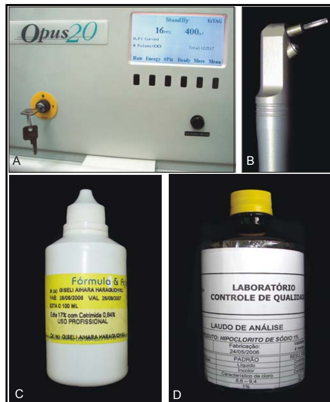
Figura 5. Soluções e Laser utilizados para o tratamento da dentina. A) Aparelho de Laser Er: YAG; B) Ponta do laser de safira, utilizada no experimento; C) EDTAC a 17%; D) Hipoclorito de sódio a 1%.
