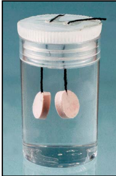
Figura 5. - Corpos-de-prova suspensos por fixação dos fios de nylon no interior de recipiente plástico com tampa.
