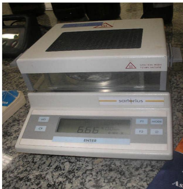
Figura 4.4 Verificando umidade do RSS em laboratório
