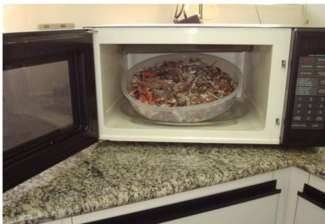
Figura 4.3 Microondas utilizado no estudo da desinfecção de RSS
