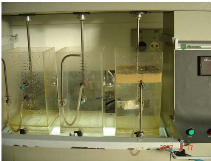
Figura 32 - Foto do ensaio de flotação com taxa de recirculação 150%
