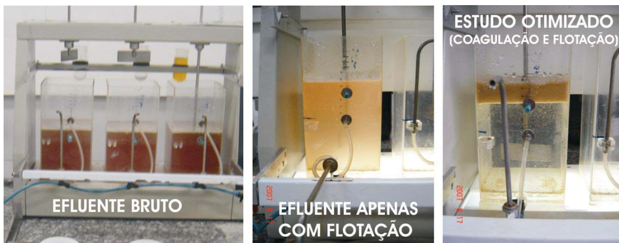
Figura 35 – Fotos do estudo otimizado – Coagulação, floculação e flotação
