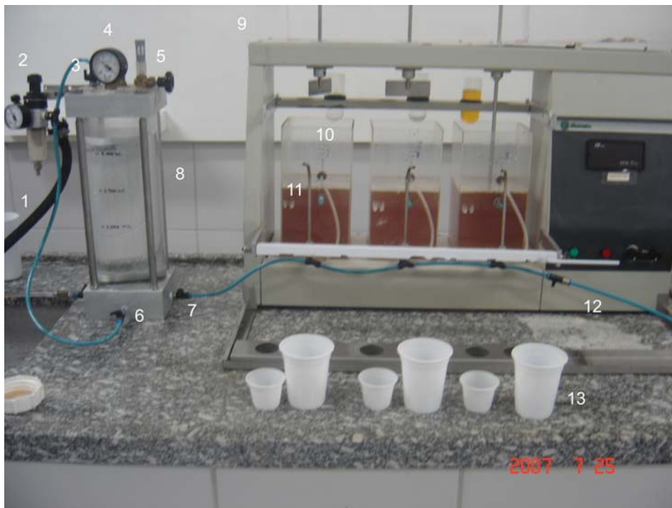
Figura 17 – Floteste 1) Mangueira de entrada de ar comprimido 2) Regulador de pressão 3) Equalização de pressão na câmara de saturação 4) Manômetro 5) Válvula de alívio de pressão 6) Registro de entrada de ar comprimido na câmara de saturação 7) Mangueira de saída de água de recirculação 8) Câmara de saturação 9) Agitadores 10) Cubas 11) Coletor de amostras 12) Mangueira de descarte de água de recirculação 13) Recipientes para coleta de amostras.
