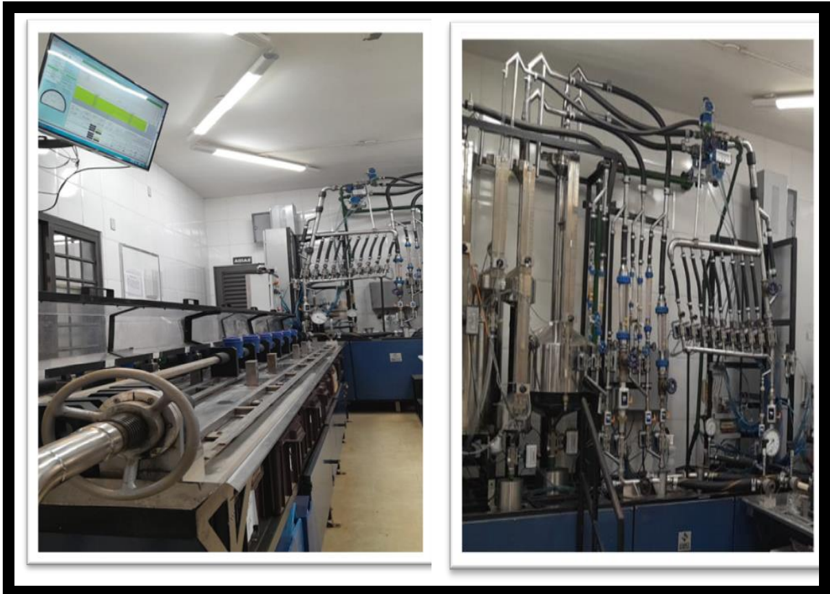
Figura 27: Imagem bancada de hidrometria DAAE, com tela software e tanque volumétrico de aferição
