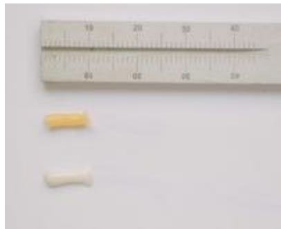
Figura 11: Padronização do comprimento do cimento resinoso para espatulação.
