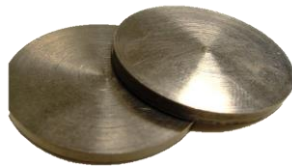
Figura 1. Discos de titânio usinado, comercialmente puro (13mmx 1,5mm)
