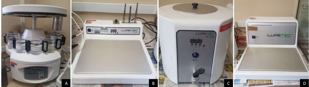
Figura 8. Sequência de processamento histológico para inclusão em parafina dos espécimes. (A) Processador de tecidos. (B) Placa aquecida. (C) Dispensador de parafina. (D) Placa refrigeradora.
