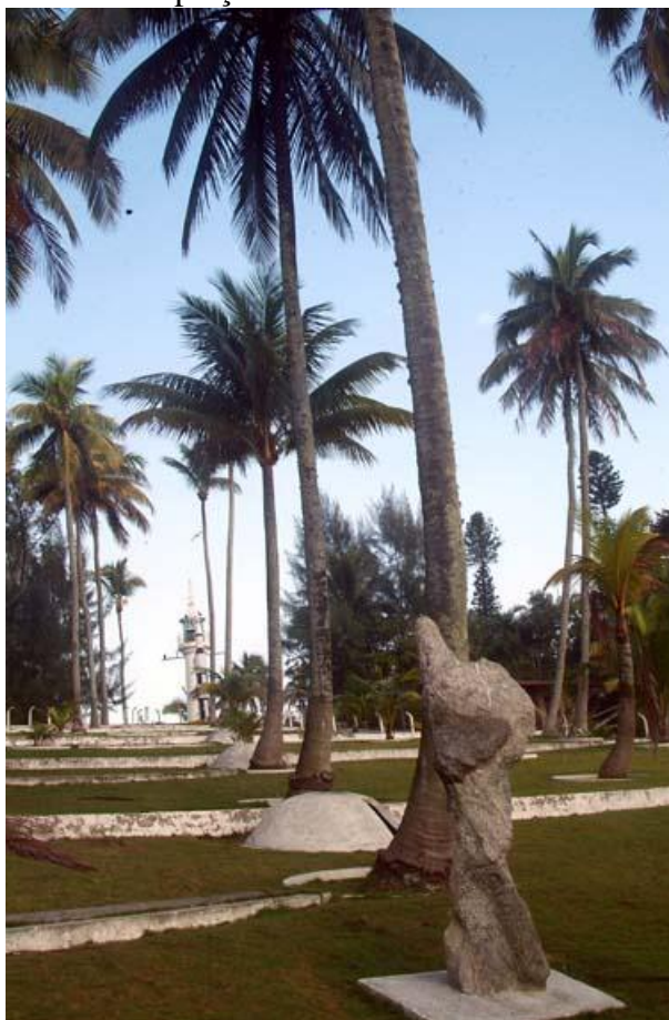
Figura 28 - Degraus para captação de águas pluviais tornada potável através de um sistema de captação da Ilha dos Arvoredos
