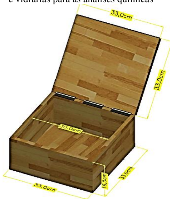
Figura 77 - Caixa construída com madeira reciclada para armazenamento dos reagentes e vidrarias para as análises químicas
