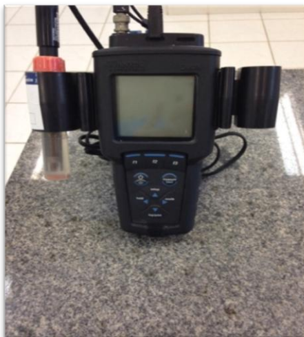
Figura 4. pHmetro Thermo Scientific Orion, utilizado na análise de pH.
