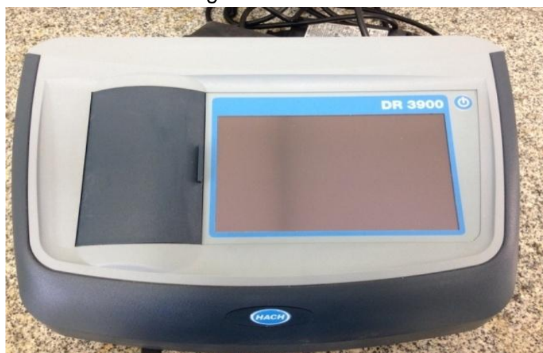
Figura 6. Espectrofotômetro DR 3900 – HACH, utilizado nas análises da série de nitrogênio e fosfato.
