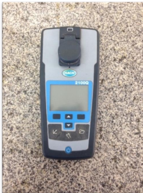
Figura 5. Turbidímetro 2100Q – HACH, utilizado na análise de turbidez.
