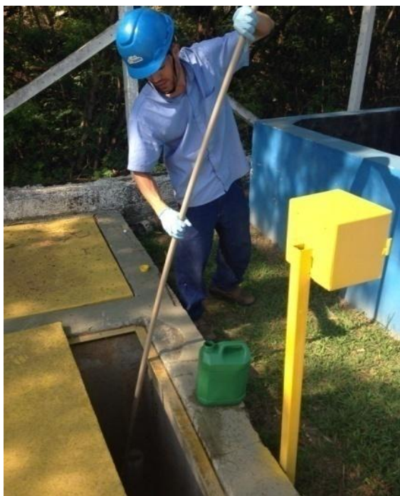
Figura 39. Coleta da entrada da ETE Salto do Guimarães.
