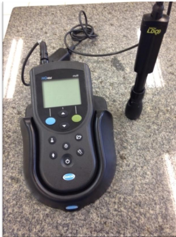
Figura 7. Medidor Multiparâmetros, utilizado para análise de Oxigênio Dissolvido.
