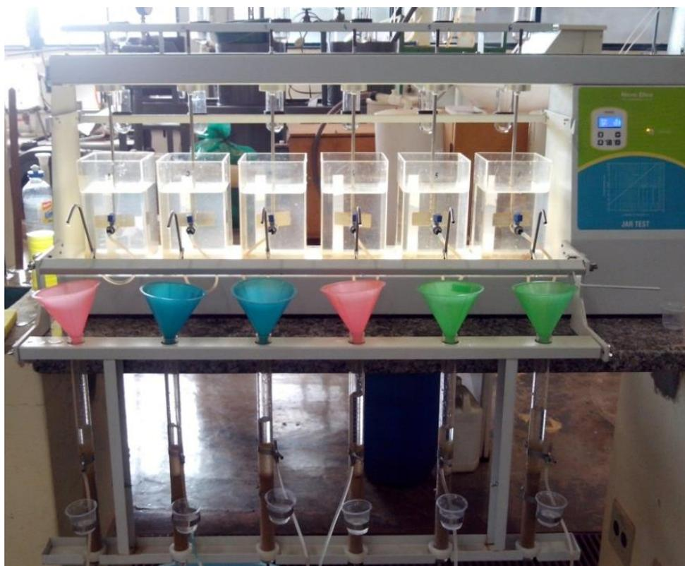
Figura 10 Equipamento de Jarrest com sistema de filtro de areia.
