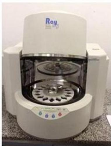
Figura 4.17 - Espectrofotômetro da UFSCar, utilizado no ensaio de fluorescência de raios-X.
