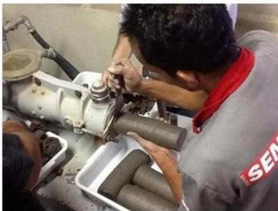
Figura 4.8 - Corte dos corpos-de-prova no SENAI-BH, após extrusão das argilas.
