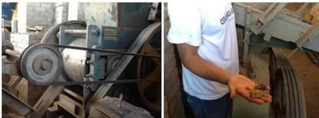
Figura 3.12 - Detalhe do processo de desintegração da argila.
