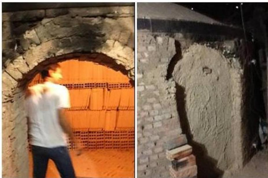
Figura 3.17 - Detalhe dos fornos para queima das telhas e tijolos.
