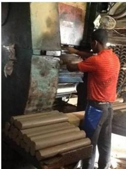
Figura 3.15 - Detalhe da prensagem dos tarugos na forma da telha desejada.
