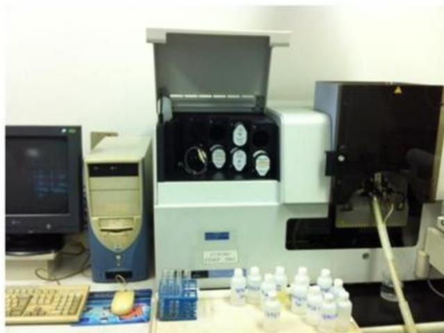
Figura 4.15 - Detalhe do equipamento para análise de composição de metais na escória com espectrofotômetro de Absorção Atômica.
