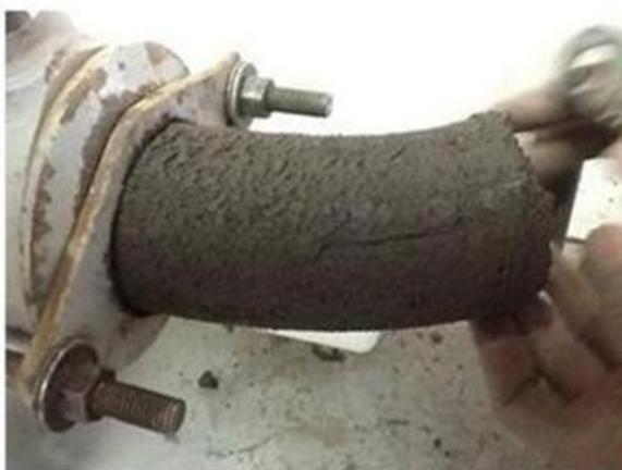
Figura 4.10 - Detalhe da extrusão de argila com bocal cilíndrico.
