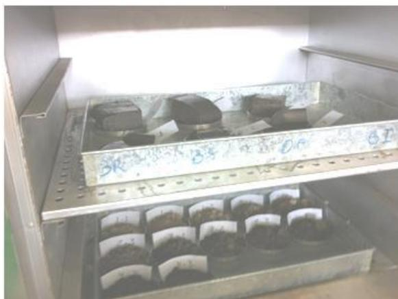
Figura 4.14 - Detalhes dos corpos-de-prova em forno para análise de umidade pós extrusão.
