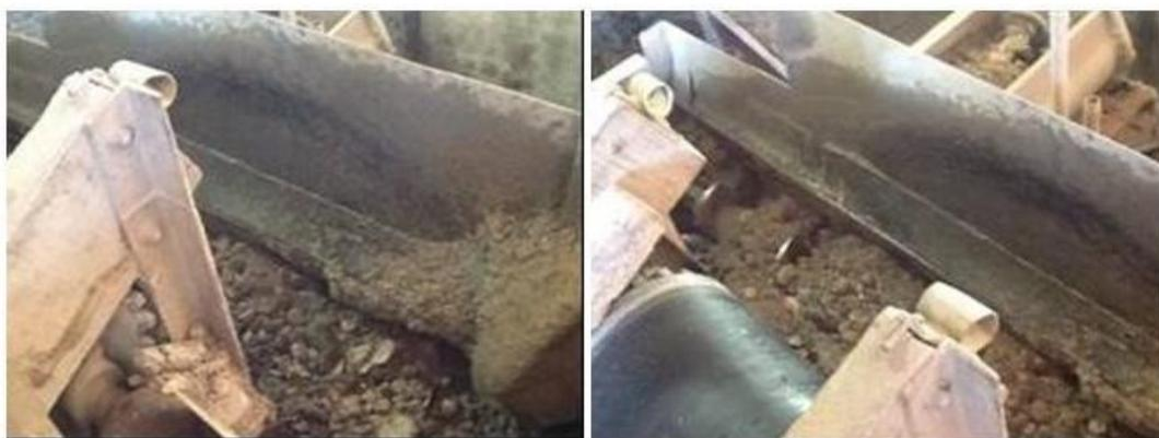
Figura 3.13 - Detalhe da mistura e laminação da argila.
