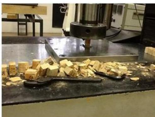
Figura 4.24 - Detalhe do ensaio de compressão de corpo-de-prova.
