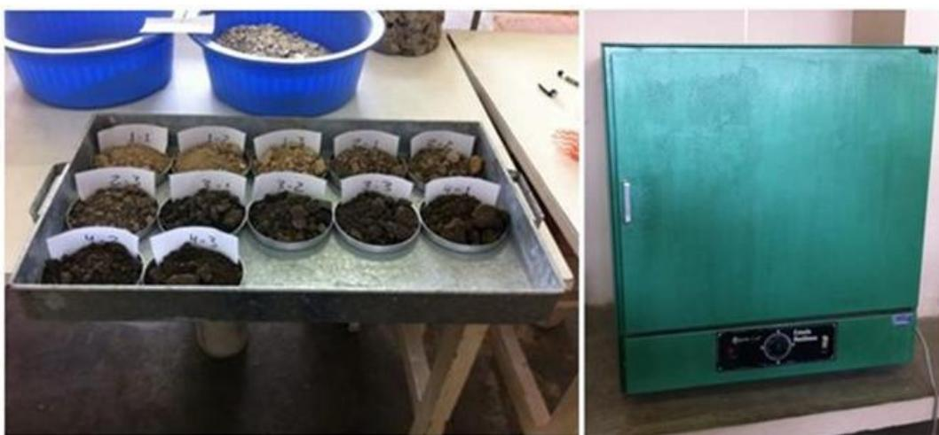
Figura 4.13 - Detalhes do ensaio de umidade das argilas da cerâmica em estudo.
