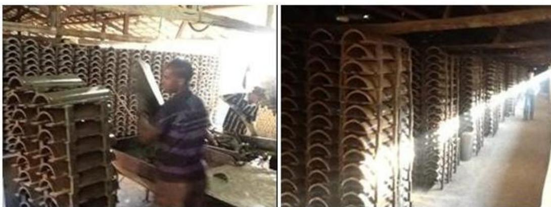
Figura 3.16 - Detalhe da secagem das telhas para aguardar a queima.
