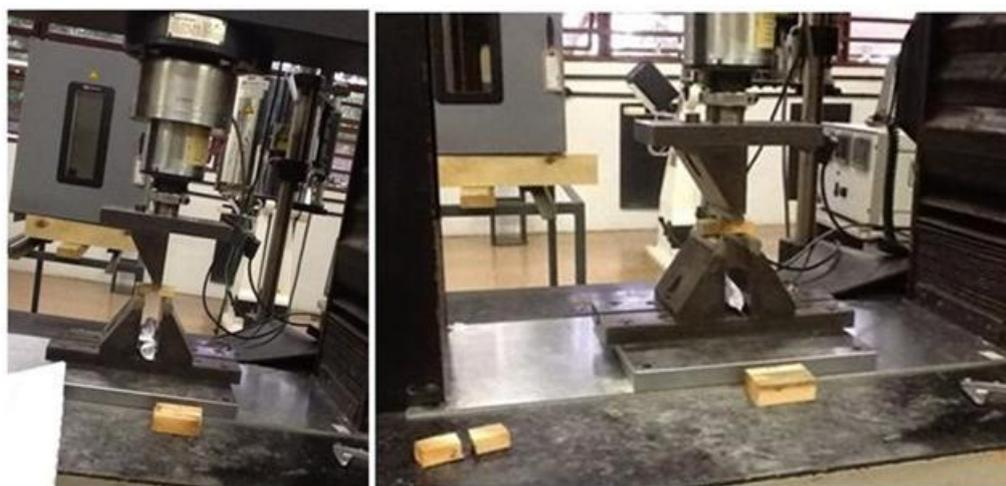
Figura 4.23 - Detalhes do ensaio de ruptura por flexão.
