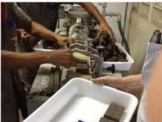
Figura 4.9 - Detalhe da geração de corpos-de-prova de seção retangular.
