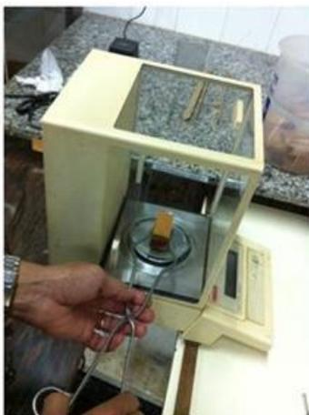
Figura 4.21 - Detalhes dos corpos-de-prova para obtenção da massa úmida.
