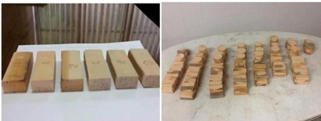
Figura 5.17 - Corpos-de-prova queimados na indústria Cerâmica Avante.
