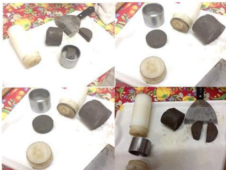
Figura 4.11 - Detalhes do processo de prensagem da massa extrudada para geração dos corpos-de-prova em forma de bolacha.
