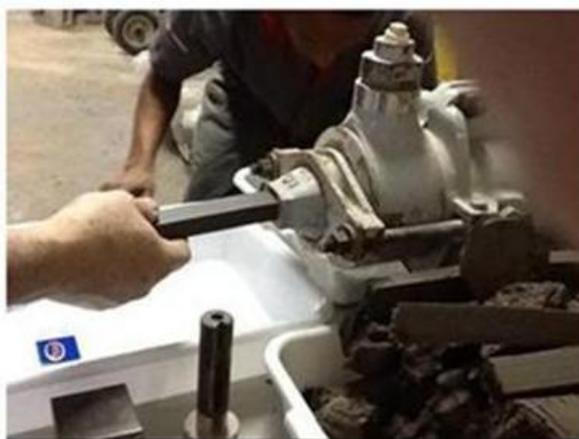
Figura 4.12 - Geração de corpo-de-prova com boquilha retangular.
