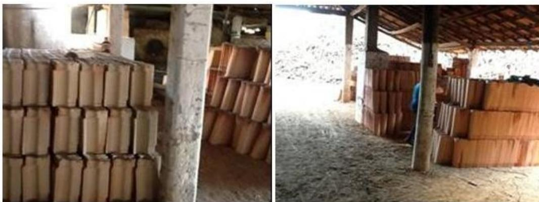
Figura 3.18 - Detalhe da estocagem das telhas após a queima.
