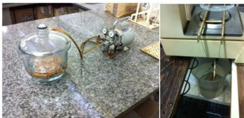
Figura 4.20 - Detalhes dos corpos-de-prova para obtenção das massas úmida e imersa.
