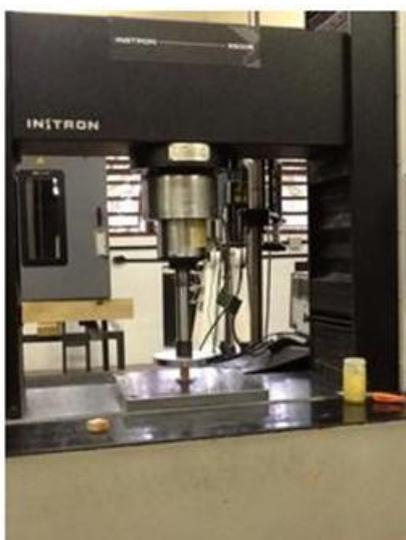
Figura 4.22 - Detalhe da prensa elétrica Universal de ensaios.
