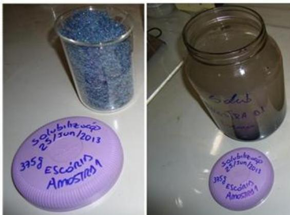
Figura 4.16 - Detalhe de amostra para ensaio de solubilização da escória.
