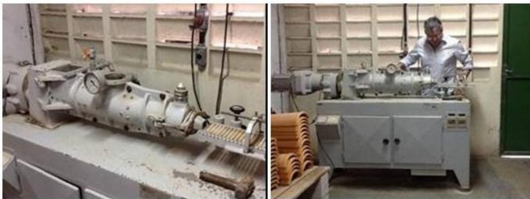
Figura 4.7 - Detalhes da extrusora usada no SENAI-BH, para geração dos corpos-de-prova.
