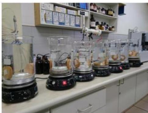
Figura 4.27 - Detalhes dos corpos-de-prova para obtenção do extrato lixiviado.
