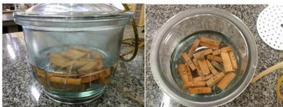
Figura 4.19 - Detalhes dos corpos-de-prova imersos em água com vácuo.
