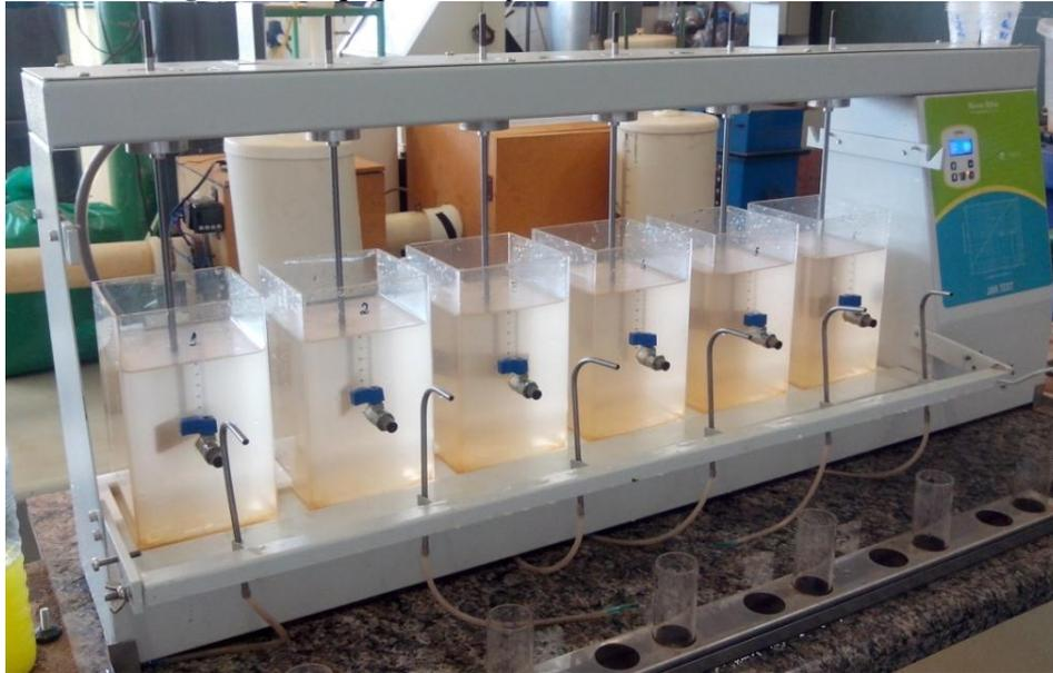
A Figura 14 mostra as amostras de água decantada coletadas para realização das leituras de cor aparente e turbidez.
