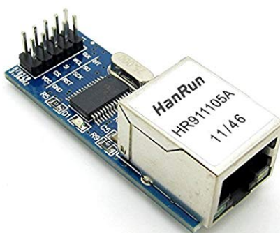
Figura 11 - Módulo Ethernet – ENC28J60 – para controle de comunicação
