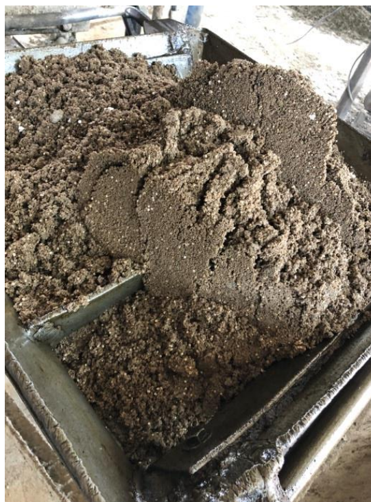
Figura 65. Material sendo colocado na máquina de blocos de concreto para realizar as Amostras dos blocos de concreto
