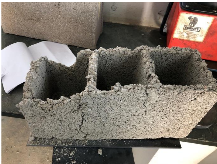
Figura 120. Bloco de concreto convencional após o teste de resistência
