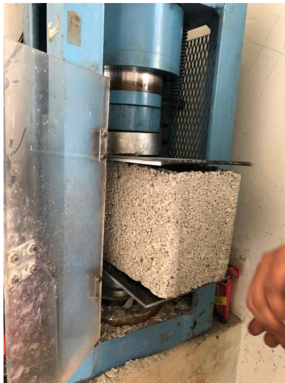
Figura 119. Momento da ruptura no teste de resistência do bloco de concreto convencional
