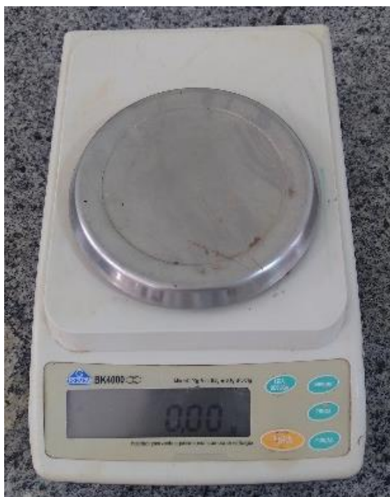
Figura 76. Balança eletrônica para pesagem das telhas de concreto
