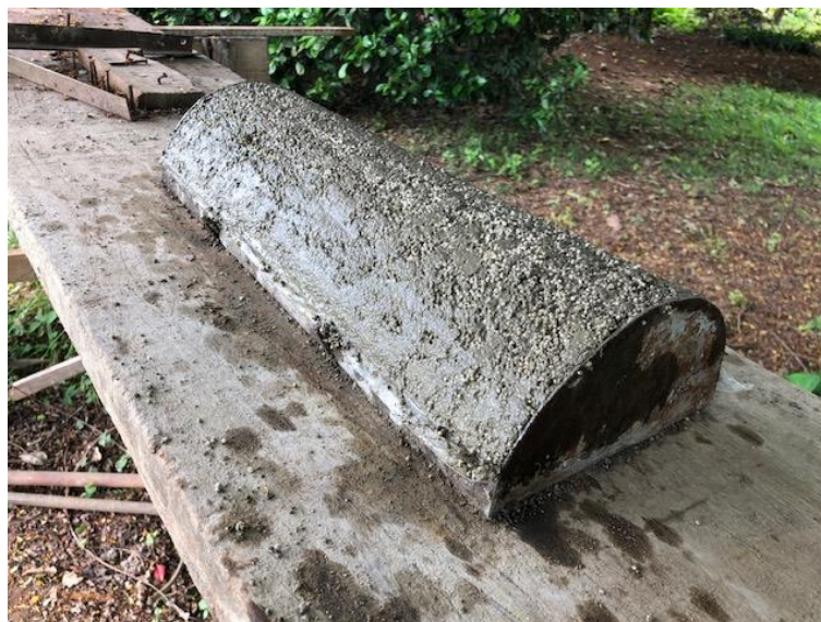
Figura 73. Telha de concreto moldada na fôrma de chapa metálica
