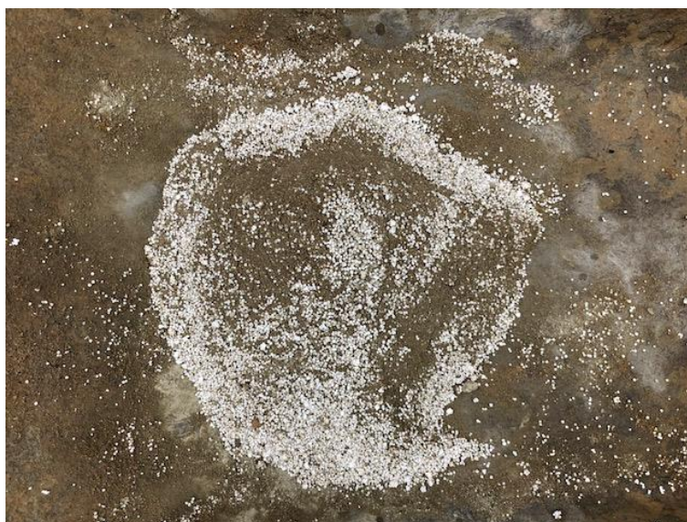
Figura 70. Materiais secos sendo misturados para continuar o desenvolvimento das Amostras das telhas de concreto
