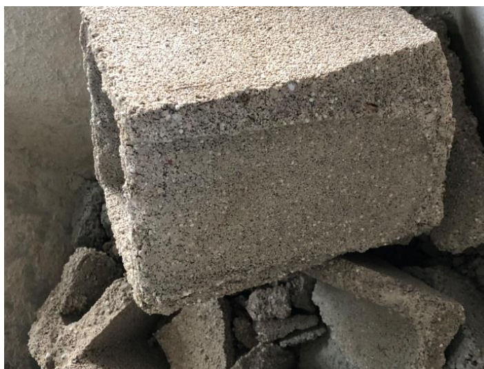
Figura 138. Bloco de concreto com redução de 60% do agregado (areia) após o teste de resistência
