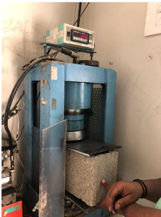
Figura 134. Momento da ruptura no teste de resistência do bloco de concreto com redução de 50% do agregado (areia)
