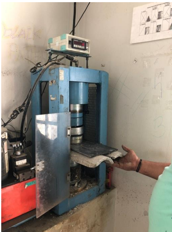
Figura 155. Teste de resistência na telha de concreto com redução de 20% do agregado (areia)
