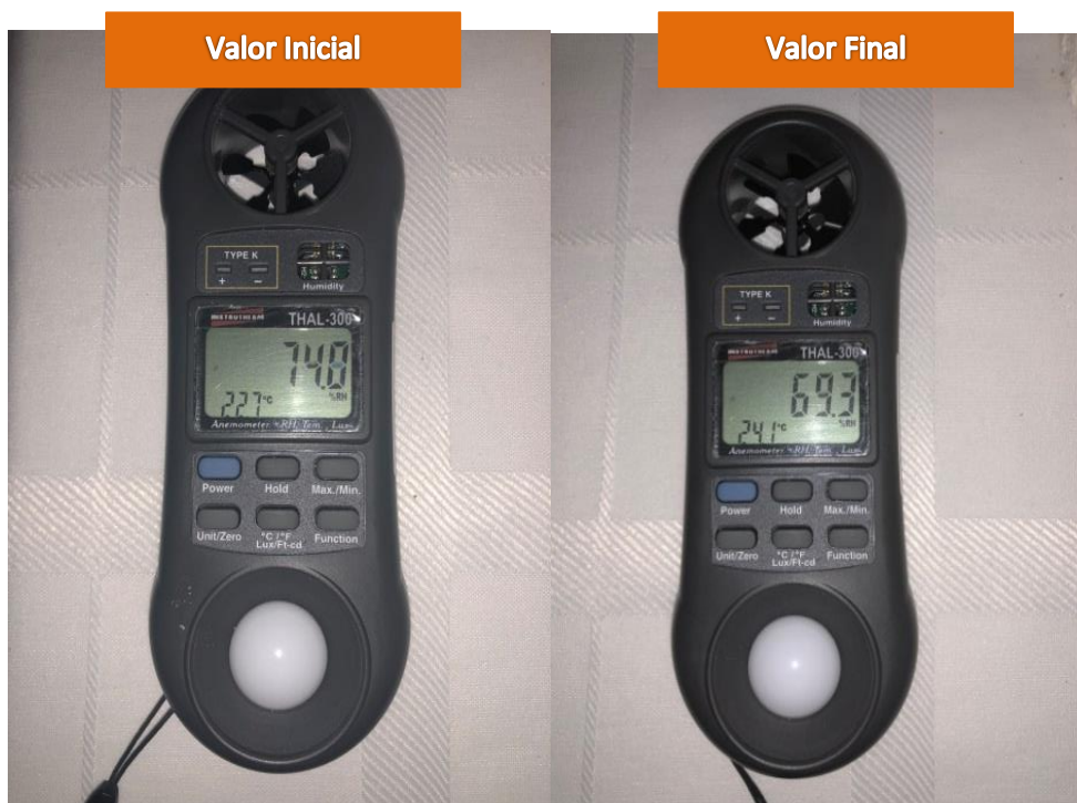
Figura 115. Resultado do teste térmico realizado com o bloco de concreto da Amostra 05
