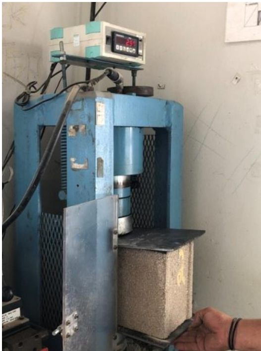
Figura 125. Momento da ruptura no teste de resistência do bloco de concreto com redução de 20% do agregado (areia)
