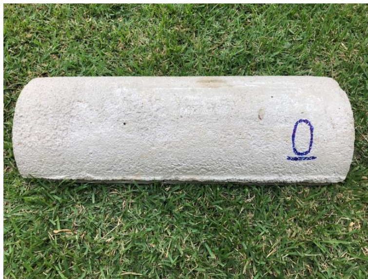
Figura 99. Telha de concreto convencional com areia
