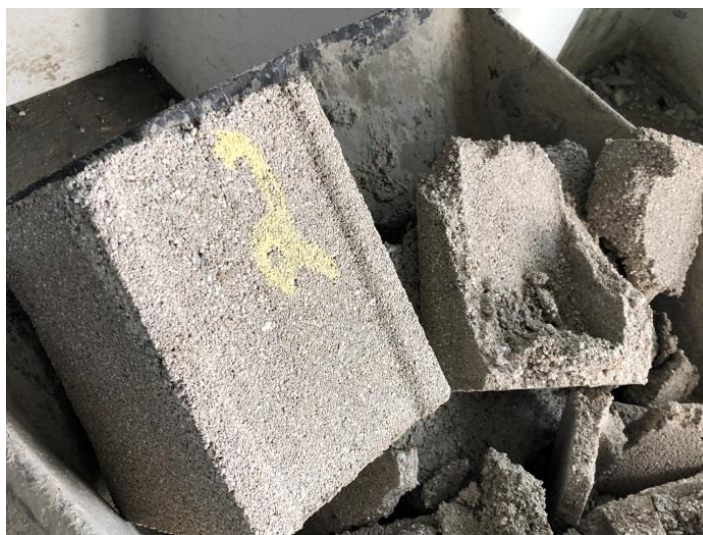
Figura 126. Bloco de concreto com redução de 20% do agregado (areia) após o teste de resistência
