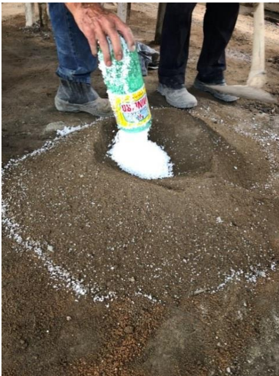
Figura 61. Resíduos de EPS sendo acrescentados ao cimento e a areia para o desenvolvimento das Amostras dos blocos de concreto
