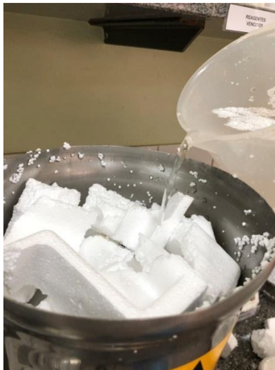
Figura 52. Água sendo adicionada aos resíduos de EPS no liquidificador
