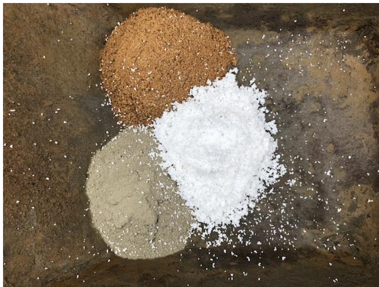
Figura 69. Cimento, areia e EPS antes de serem misturados para o desenvolvimento das Amostras das telhas de concreto
