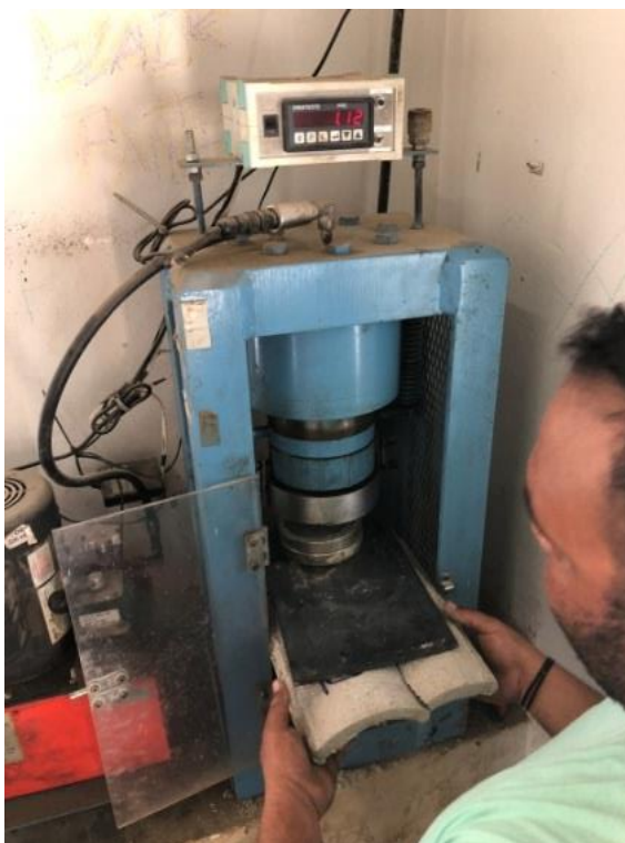
Figura 151. Teste de resistência na telha de concreto convencional apenas com areia de agregado
