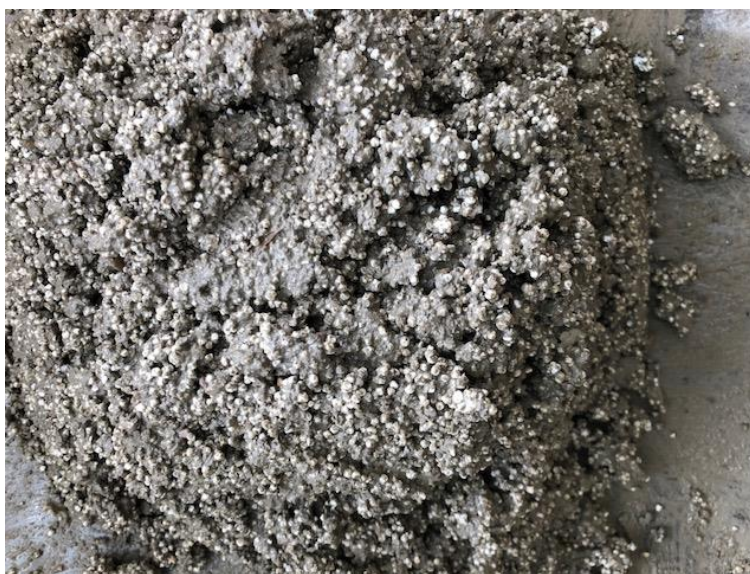
Figura 71. Massa final pronta para o desenvolvimento das Amostras das telhas de concreto
