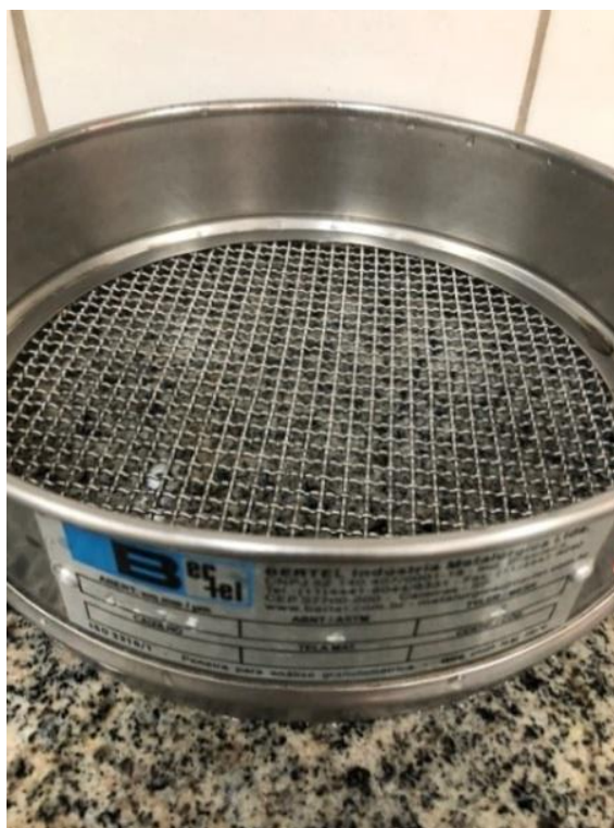
Figura 55. Peneira com abertura de 2,00 mm utilizada para escoamento do EPS
