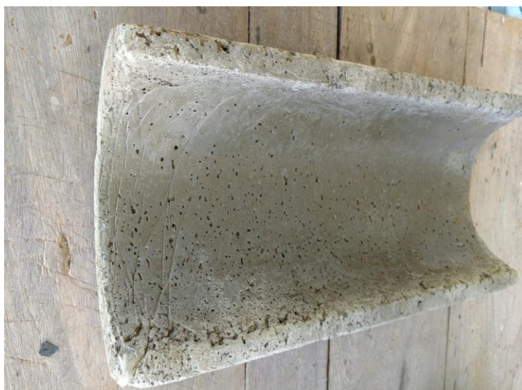
Figura 106. Parte interna da telha de concreto da Amostra 06
