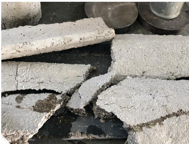
Figura 158. Telha de concreto com redução de 30% do agregado (areia) após o teste de resistência
