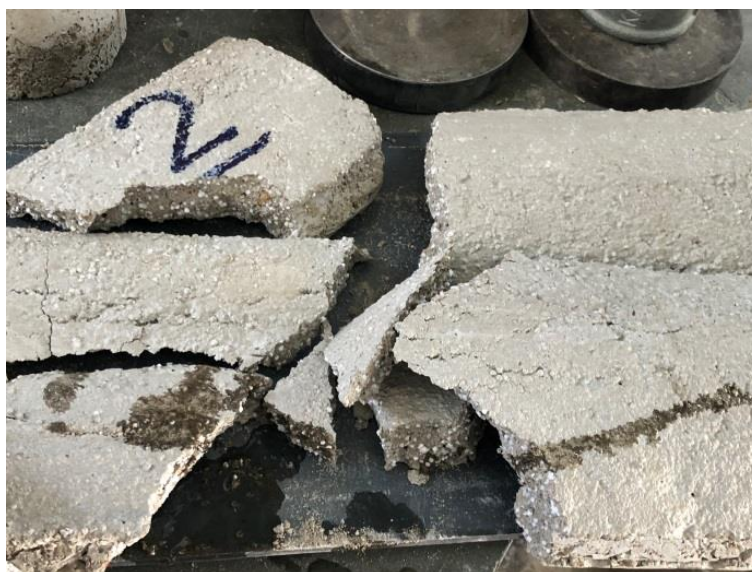
Figura 156. Telha de concreto com redução de 20% do agregado (areia) após o teste de resistência
