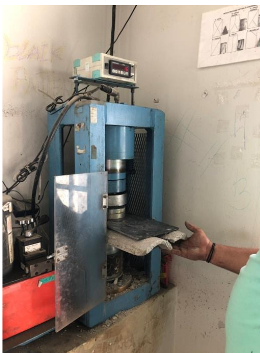
Figura 163. Teste de resistência na telha de concreto com redução de 60% do agregado (areia)
