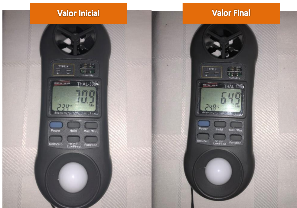
Figura 113. Resultado do teste térmico realizado com o bloco de concreto da Amostra 03
