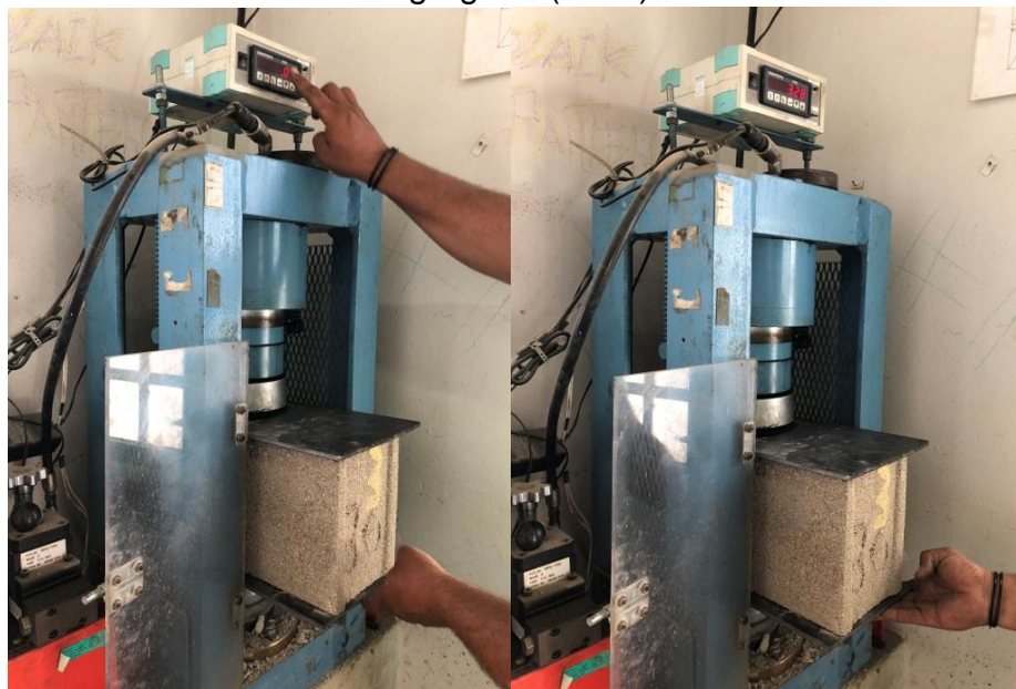
Figura 127. Teste de resistência no bloco de concreto com redução de 30% do agregado (areia)
