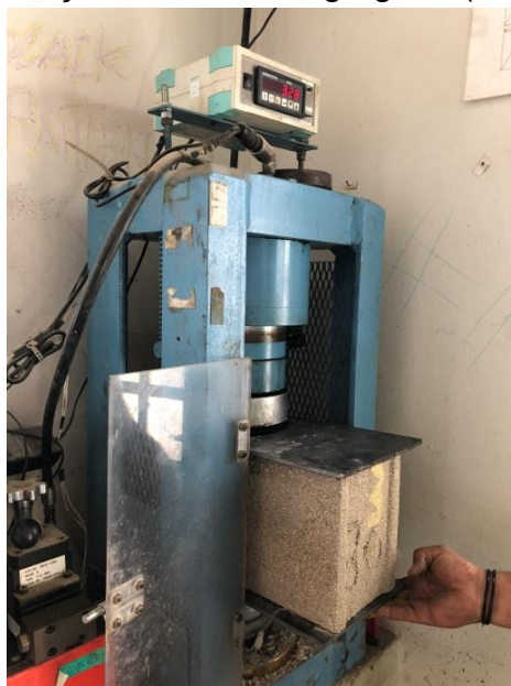
Figura 128. Momento da ruptura no teste de resistência do bloco de concreto com redução de 30% do agregado (areia)
