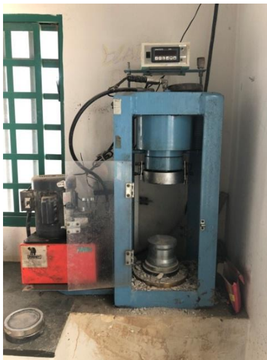
Figura 85. Início dos testes de resistência nas telhas de concreto
