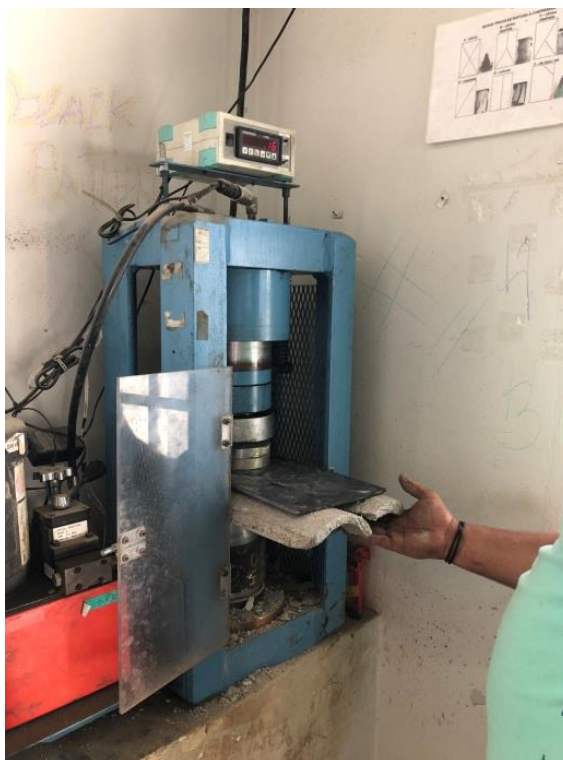
Figura 153. Teste de resistência na telha de concreto com redução de 10% do agregado (areia)
