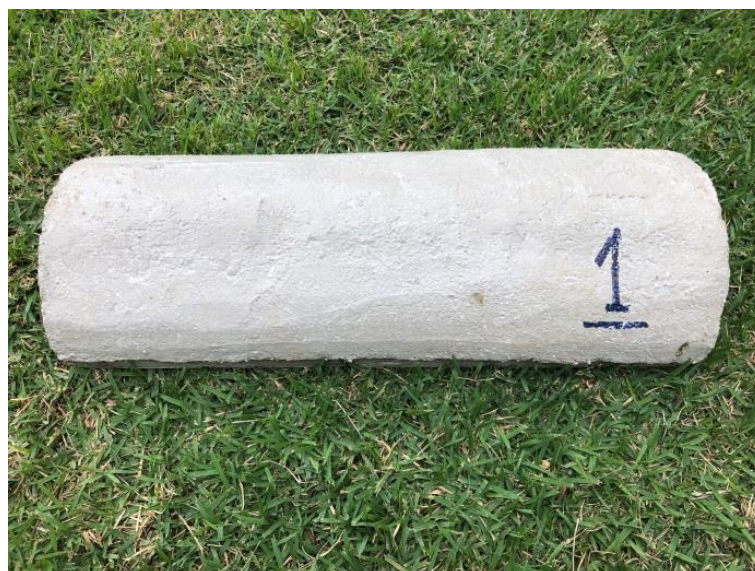
Figura 100. Telha de concreto da Amostra 01
