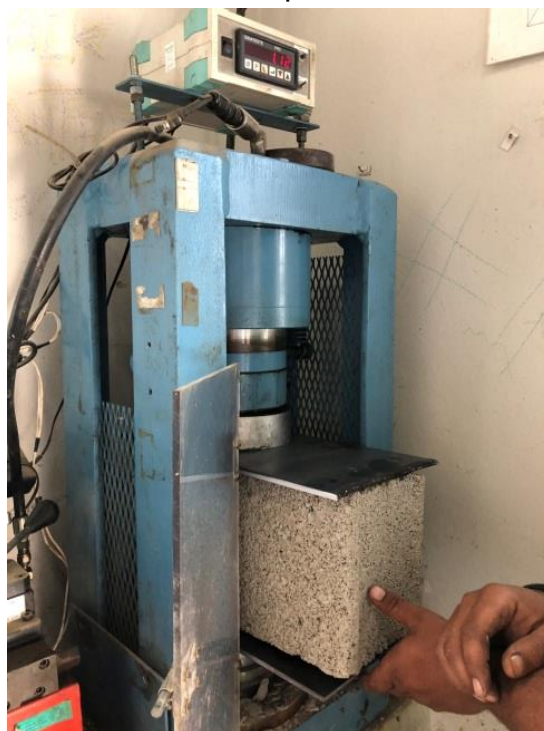
Figura 83. Bloco de concreto dentro do maquinário e início do teste de resistência
