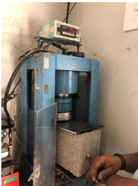
Figura 137. Momento da ruptura no teste de resistência do bloco de concreto com redução de 60% do agregado (areia)
