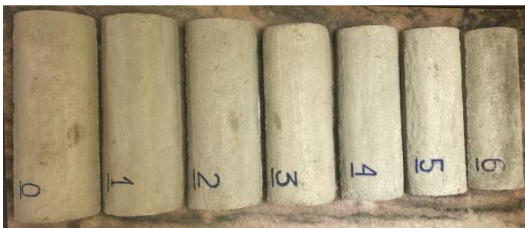
Figura 98. Telhas de concreto das amostras após o processo de cura
