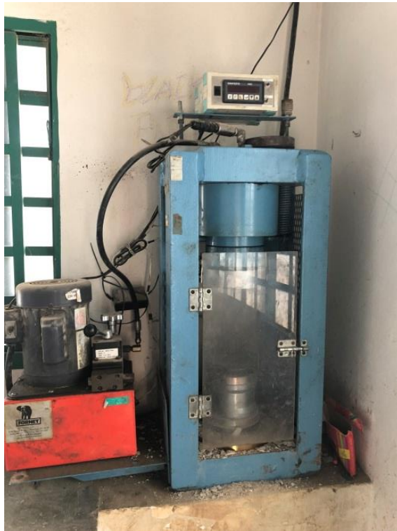
Figura 80. Maquinário utilizado para realização do teste de resistência dos blocos de concreto em estudo
