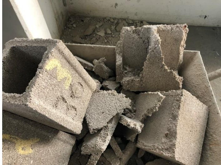
Figura 129. Bloco de concreto com redução de 30% do agregado (areia) após o teste de resistência
