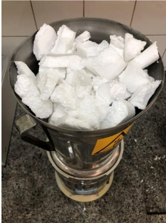
Figura 51. Copo do liquidificador com o limite de resíduos de EPS e água
