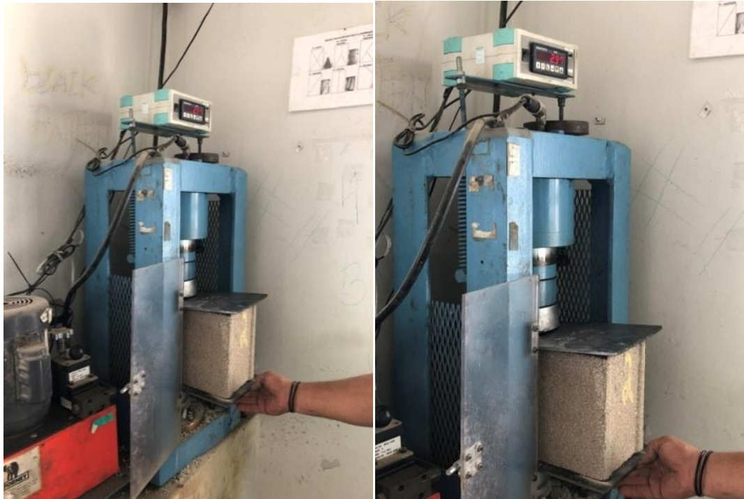
Figura 124. Teste de resistência no bloco de concreto com redução de 20% do agregado (areia)
