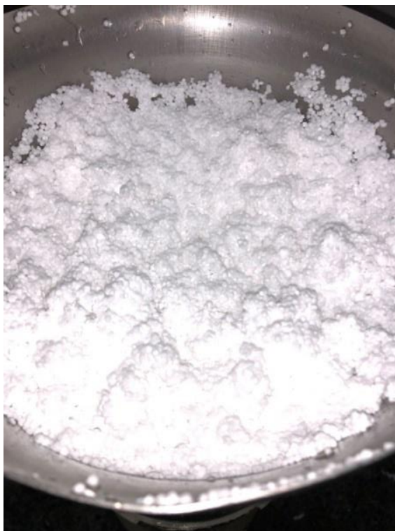
Figura 54. Resíduos de EPS após trituração em liquidificador industrial
