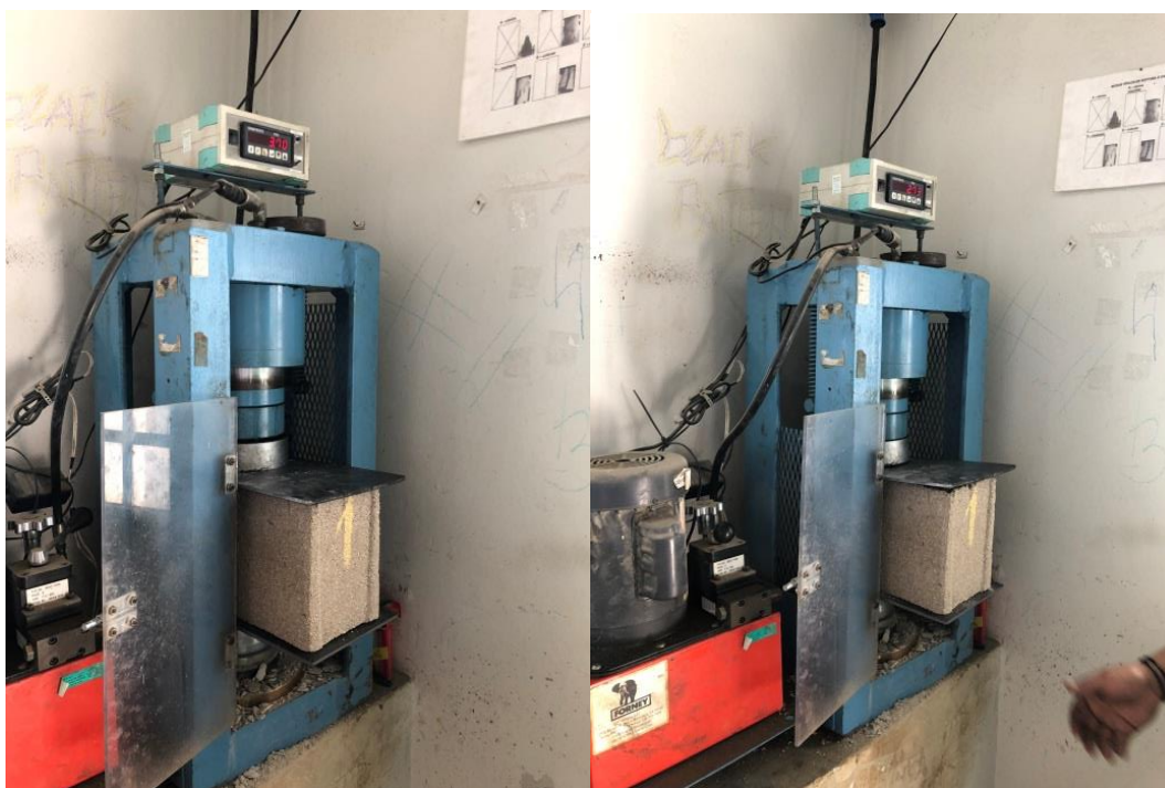
Figura 121. Teste de resistência no bloco de concreto convencional apenas com areia de agregado
