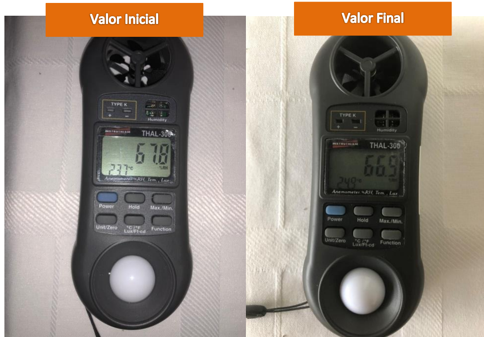
Figura 112. Resultado do teste térmico realizado com o bloco de concreto da Amostra 02
