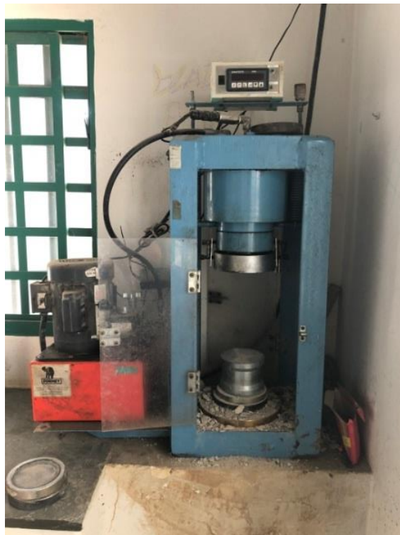
Figura 82. Início dos testes de resistência nos blocos de concreto
