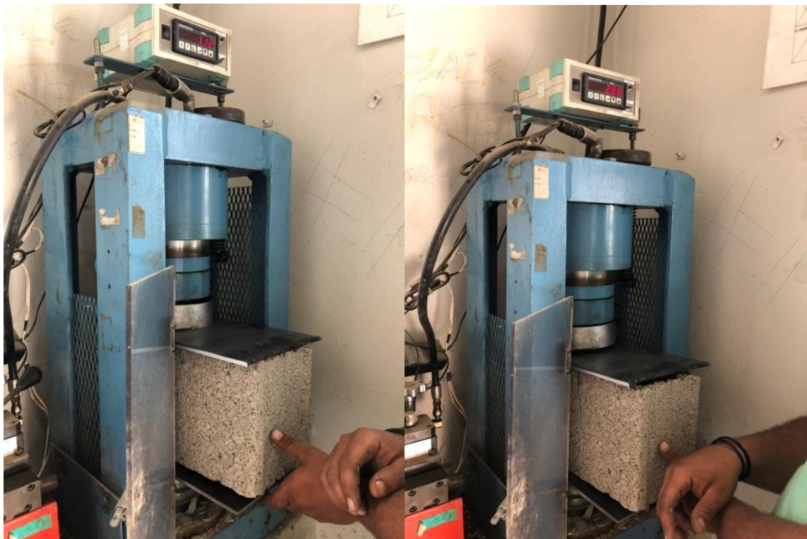
Figura 118. Teste de resistência no bloco de concreto convencional apenas com areia de agregado
