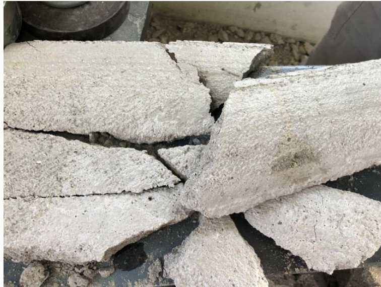
Figura 154. Telha de concreto com redução de 10% do agregado (areia) após o teste de resistência
