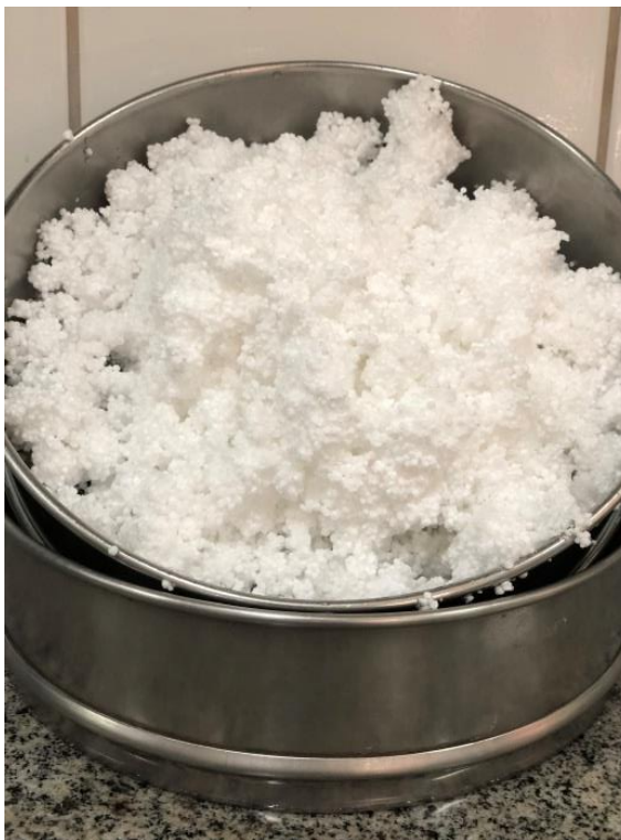
Figura 56. Resíduos de EPS na peneira com abertura de 2,00 mm para escoamento do EPS
