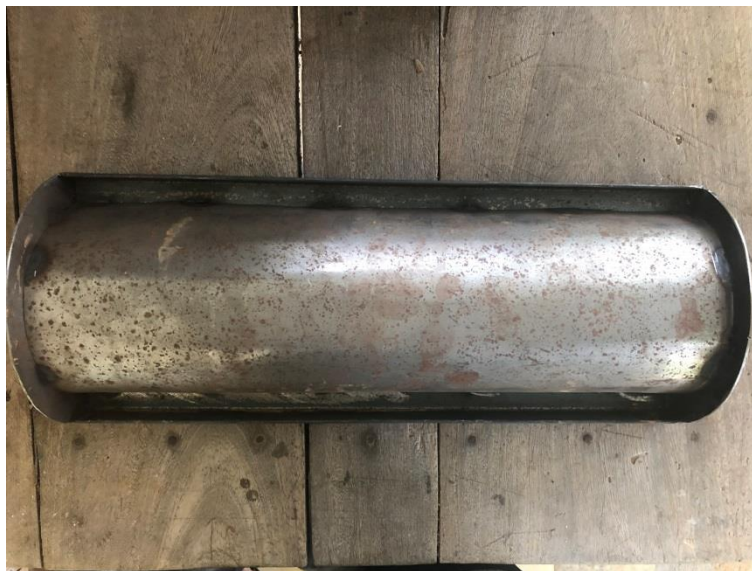
Figura 72. Fôrma utilizada para realizar as Amostras das telhas de concreto
