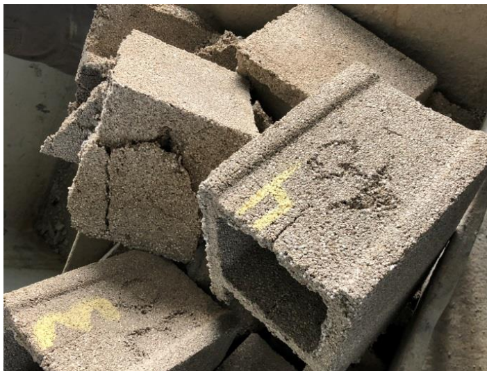
Figura 132. Bloco de concreto com redução de 40% do agregado (areia) após o teste de resistência
