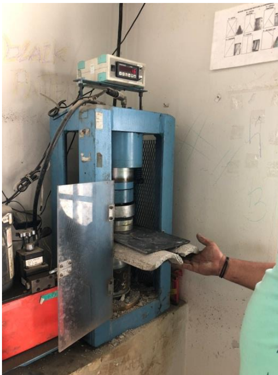
Figura 157. Teste de resistência na telha de concreto com redução de 30% do agregado (areia)
