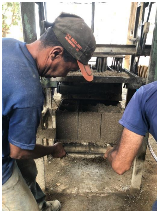
Figura 67. Máquina de blocos de concreto finalizando o processo das Amostras dos blocos de concreto
