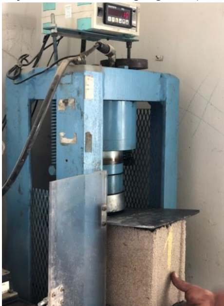
Figura 122. Momento da ruptura no teste de resistência do bloco de concreto com redução de 10% do agregado (areia)
