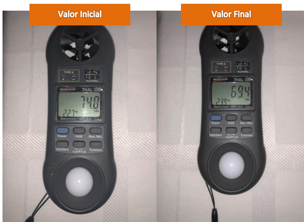
Figura 116. Resultado do teste térmico realizado com o bloco de concreto da Amostra 06
