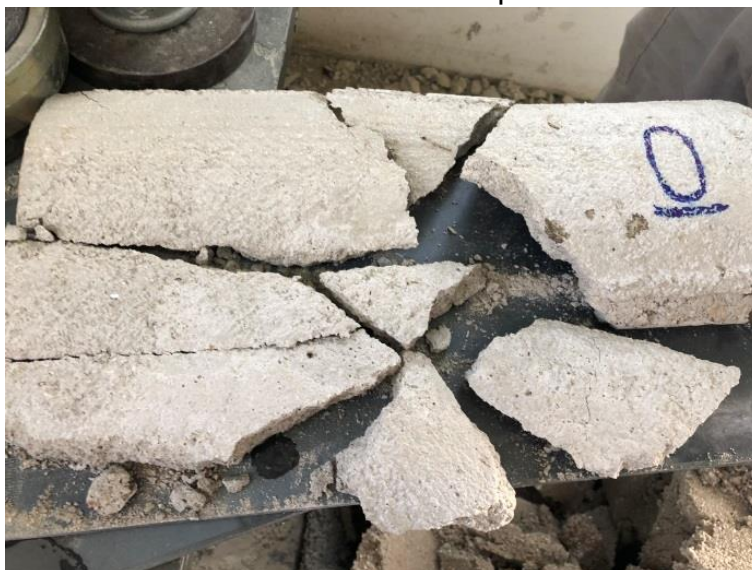
Figura 152. Telha de concreto convencional após o teste de resistência
