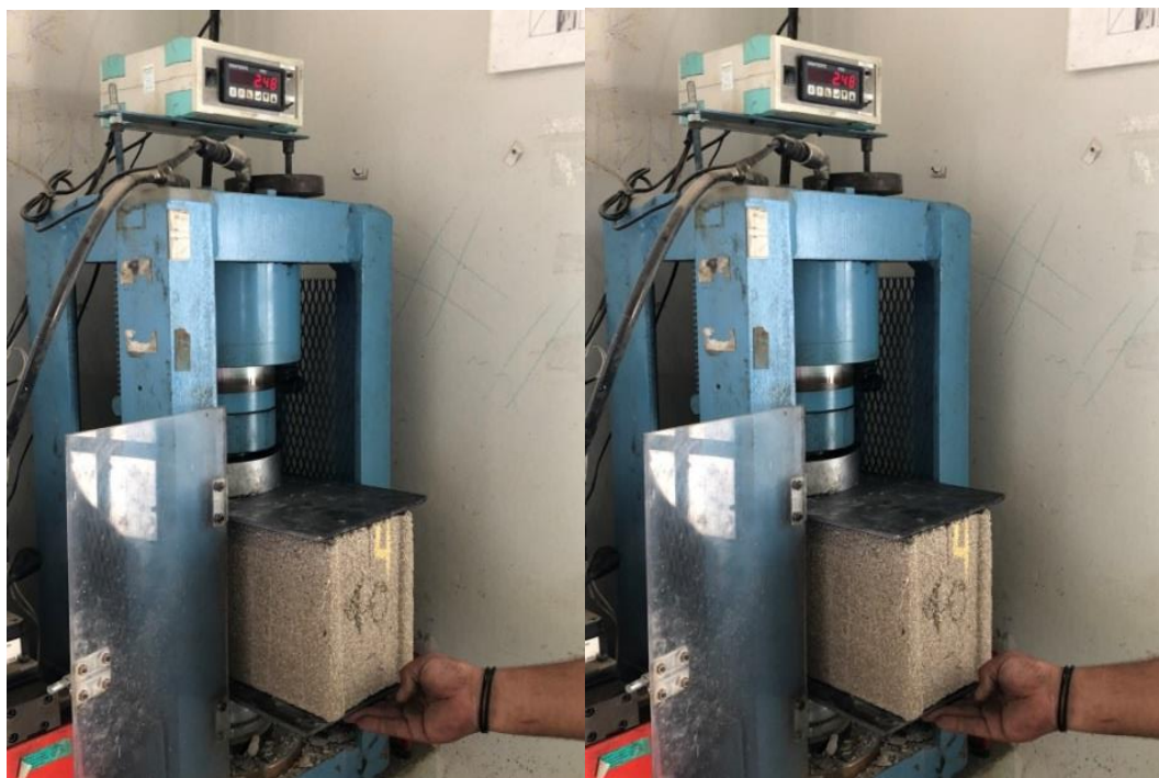
Figura 130. Teste de resistência no bloco de concreto com redução de 40% do agregado (areia)
