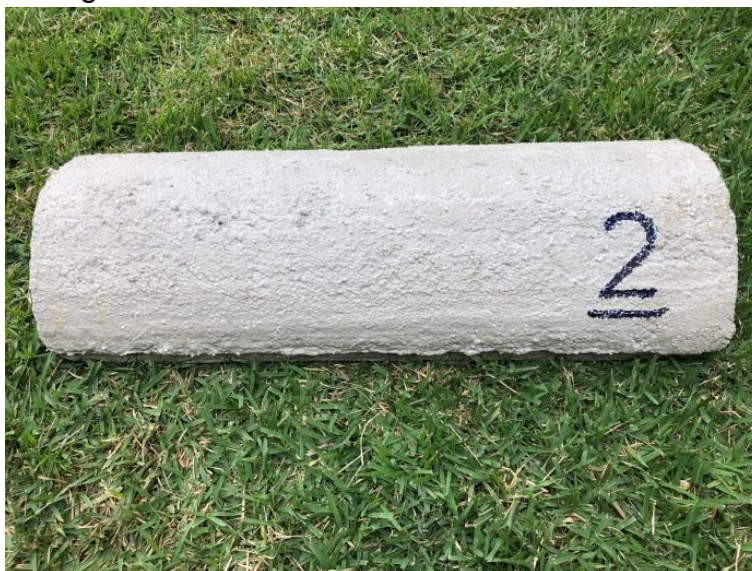
Figura 101. Telha de concreto da Amostra 02
