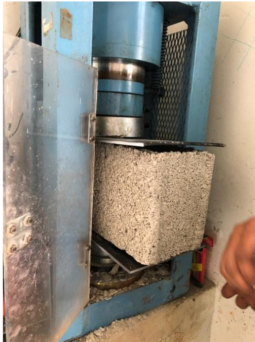
Figura 84. Compressão do aparelho atingindo a ruptura no bloco de concreto para realização do teste de resistência
