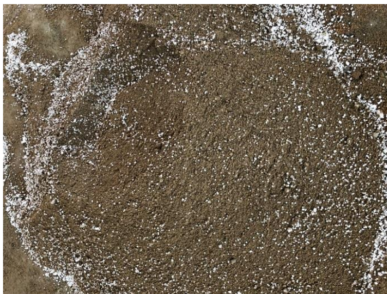
Figura 62. Materiais secos misturados para o desenvolvimento das Amostras dos blocos de concreto
