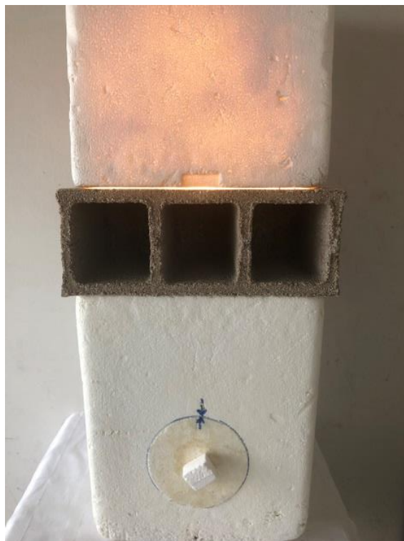
Figura 77. Caixas de “isopôr” adaptadas para o desenvolvimento dos testes de temperatura dos blocos de concreto
