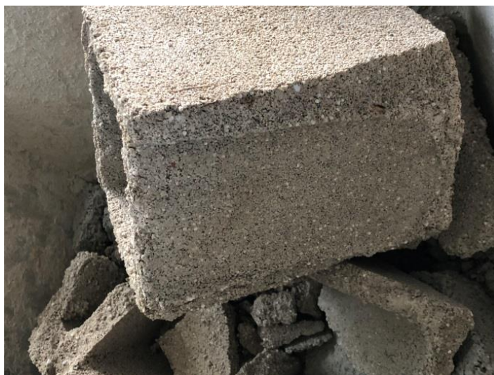
Figura 135. Bloco de concreto com redução de 50% do agregado (areia) após o teste de resistência
