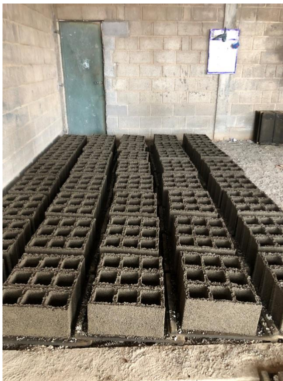
Figura 88. Amostras dos blocos de concreto com resíduos de EPS
