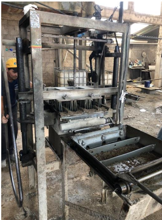
Figura 66. Maquinário utilizado para a realização das Amostras dos blocos de concreto
