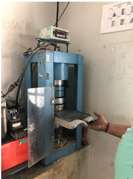
Figura 161. Teste de resistência na telha de concreto com redução de 50% do agregado (areia)
