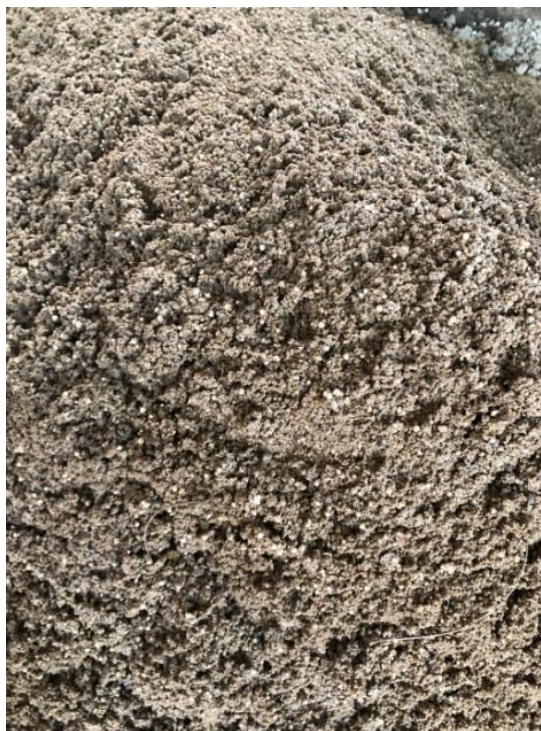
Figura 64. Material pronto antes de ir para o maquinário realizar as Amostras dos blocos de concreto
