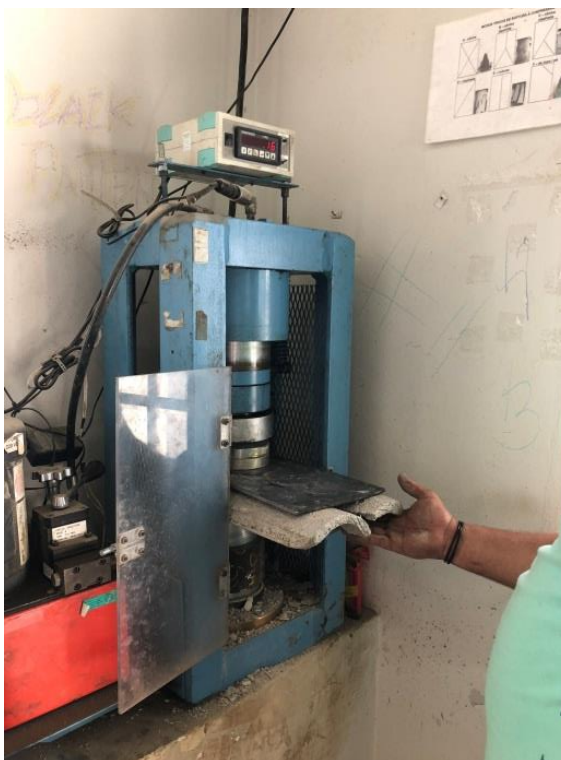
Figura 86. Telha de concreto dentro do maquinário e compressão do aparelho atingindo a ruptura para realização do teste de resistência
