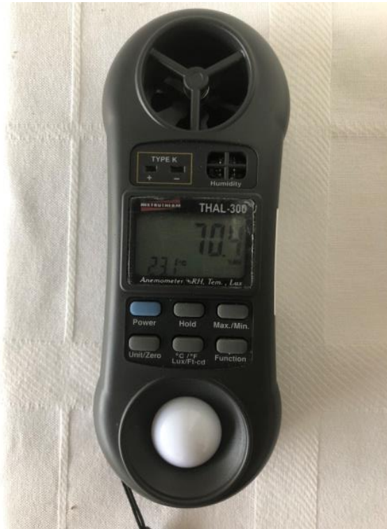
Figura 78. Aparelho Termo-Higro-Anemômetro-Luxímetro digital portátil utilizado para o desenvolvimento dos testes de temperatura dos blocos de concreto
