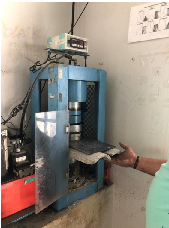
Figura 159. Teste de resistência na telha de concreto com redução de 40% do agregado (areia)
