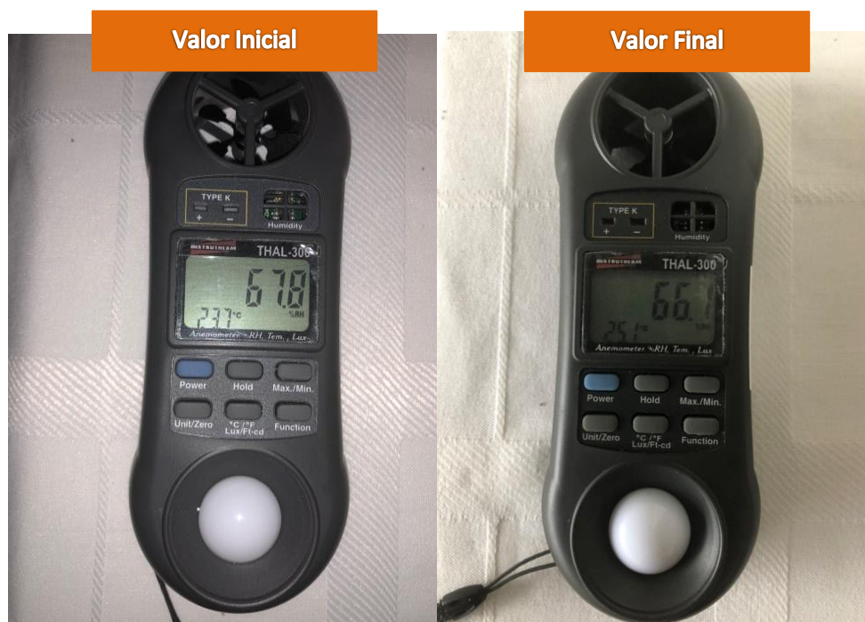
Figura 111. Resultado do teste térmico realizado com o bloco de concreto da Amostra 01
