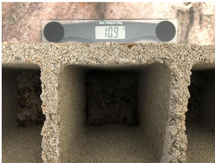
Figura 75. Pesagem realizada nos blocos de concreto
