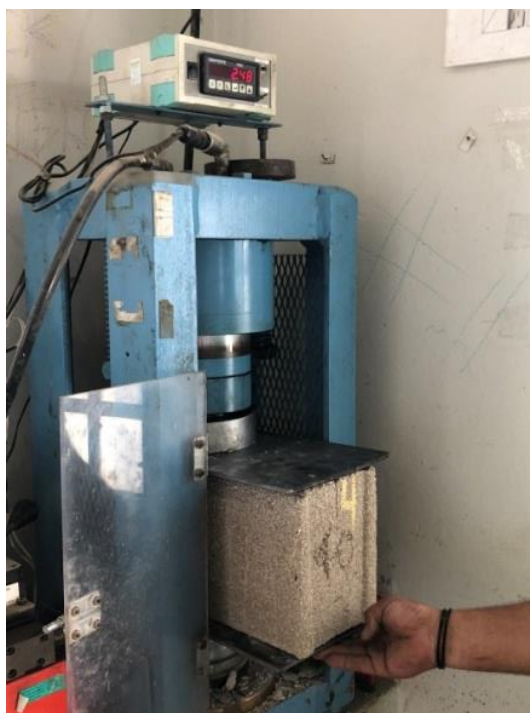
Figura 131. Momento da ruptura no teste de resistência do bloco de concreto com redução de 40% do agregado (areia)
