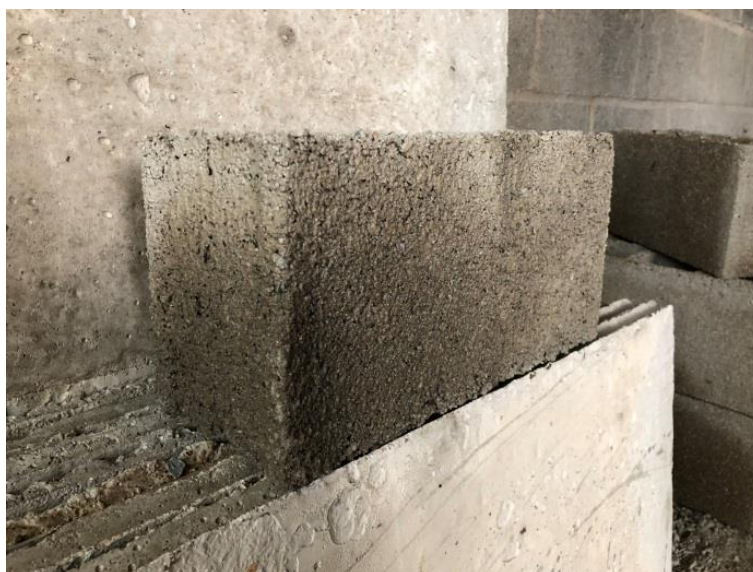
Figura 90. Bloco de concreto convencional somente com areia
