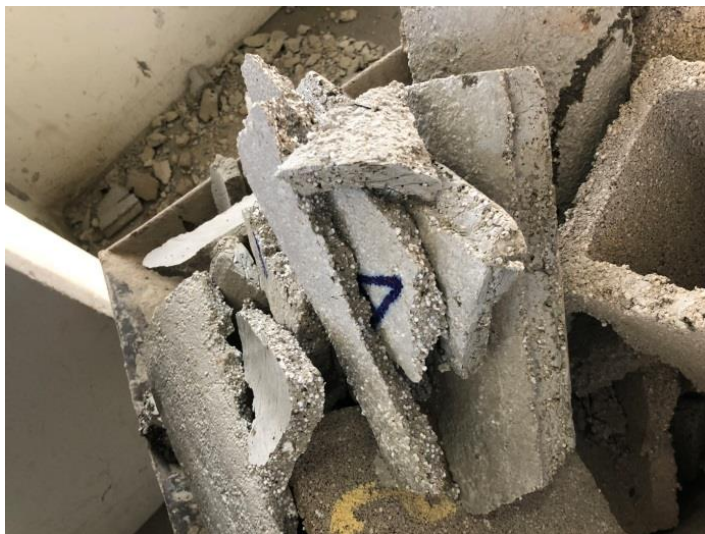
Figura 162. Telha de concreto com redução de 50% do agregado (areia) após o teste de resistência
