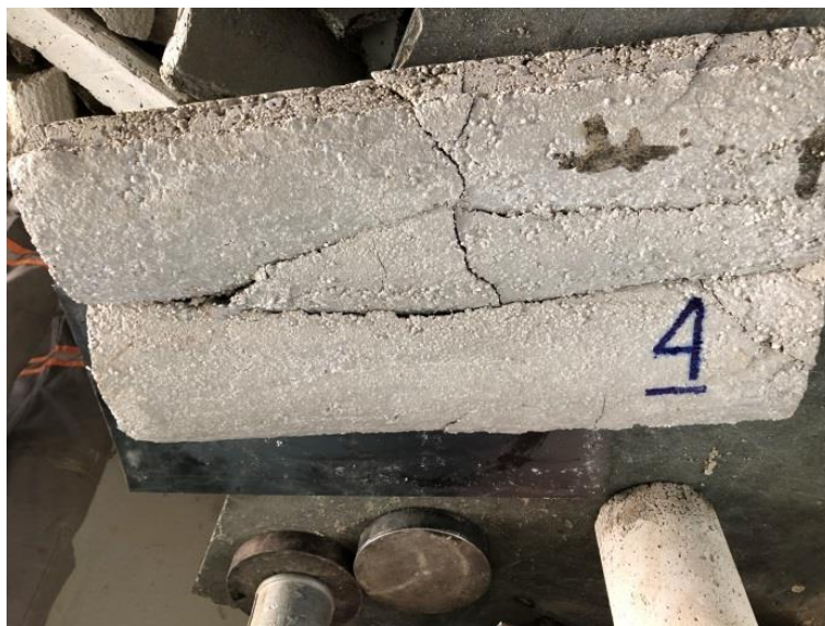
Figura 160. Telha de concreto com redução de 40% do agregado (areia) após o teste de resistência
