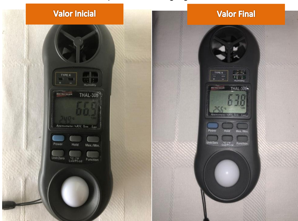
Figura 109. Resultado do teste térmico realizado com o bloco de concreto convencional composto com o agregado areia e brita
