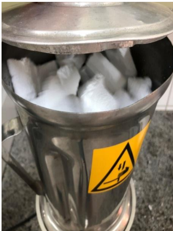
Figura 53. Resíduos de EPS sendo triturados em liquidificador industrial
