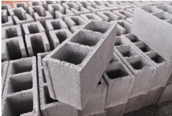
Figura 43. Blocos de concreto para vedação
