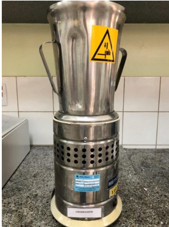
Figura 49. Liquidificador industrial utilizado para triturar os resíduos de EPS
